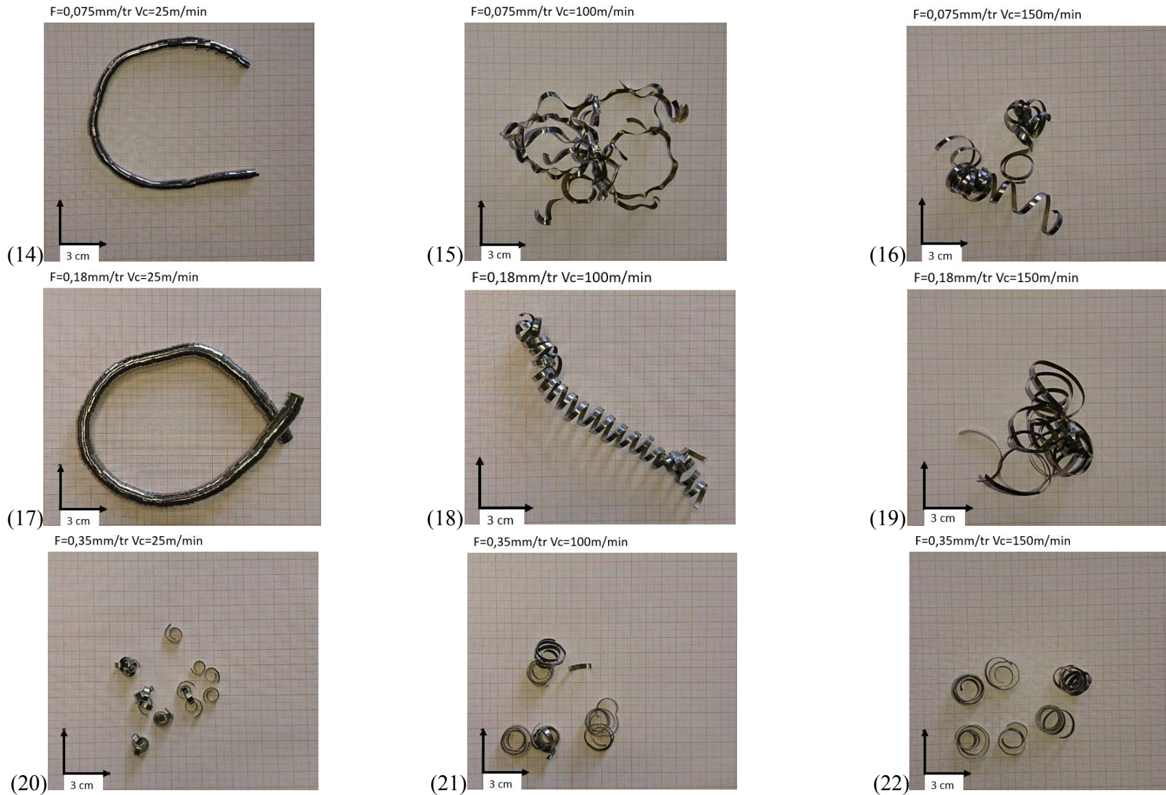
Figure II. 18. Morphologie macroscopique des copeaux de l'alliage Ti-6Al-4V en fonction des conditions de coupe.
