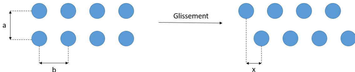
Figure I. 36. Glissement de deux plans atomiques dans un cristal parfait.
