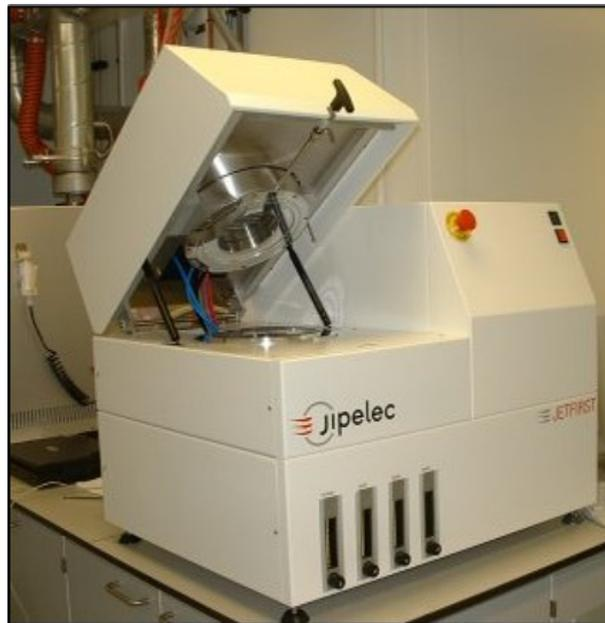
FIGURE II.4: Photographie du four à recuit rapide.
