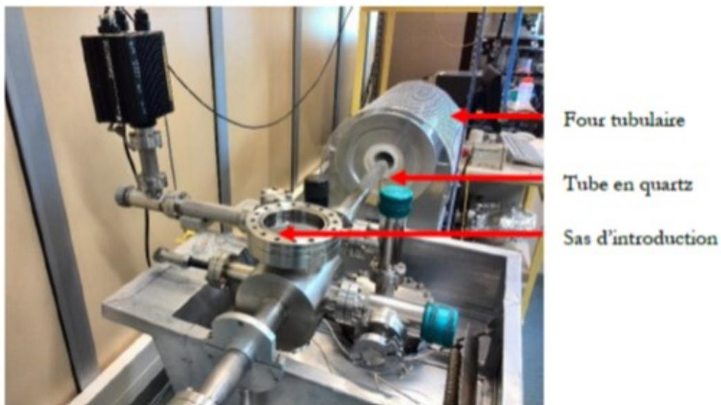
FIGURE II.3: Photographie du four tubulaire.
