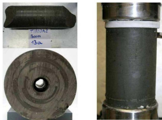
FIGURE 1.8 – Cylindre creux d'argile de Boom utilisé pour des expériences du projet TIMODAZ - [Dizier, 2011]
