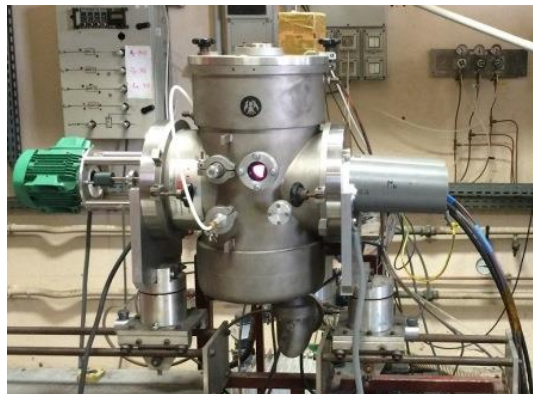
FIGURE 47 – Photo du bâti de pulvérisation provisoire qui a servi aux premiers mois de l'étude.
