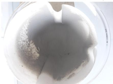
FIGURE 5.6 – Coloration des insolubles provenant des fondants routiers sur filtre sec
