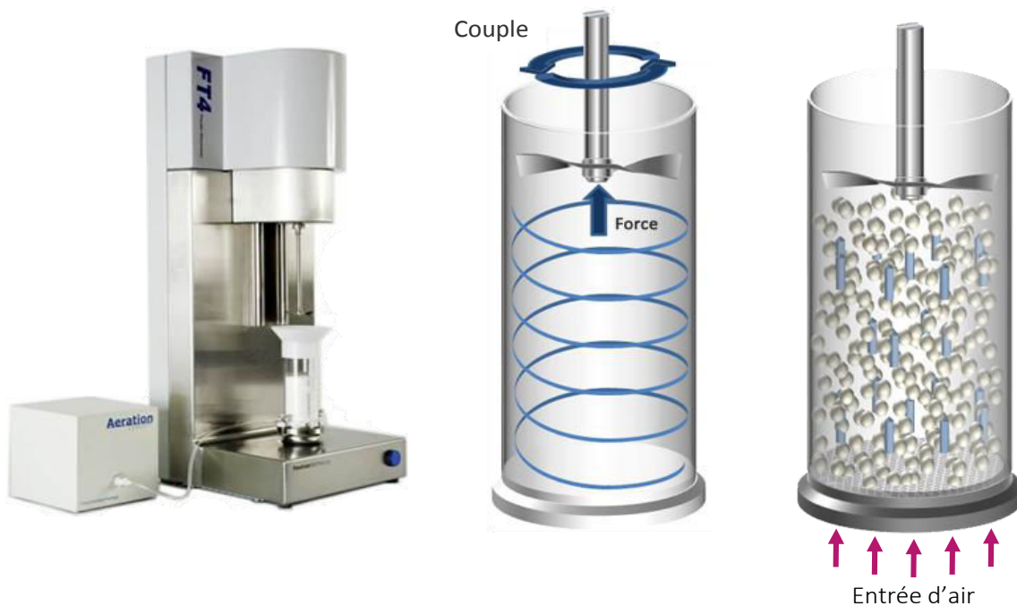
Figure 7 : Photographie du rhéomètre FT4 (gauche), principe de mesure de l'énergie de mélange du lit de poudre (milieu) et principe de mesure du programme « aération » (droite)
