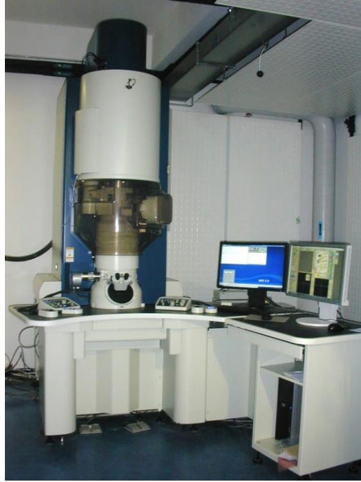
Figure II-12 : Microscope électronique en transmission JEOL ARM 200 F (cold FEG, corrigé en sonde) installé à l'IJL en novembre 2012
