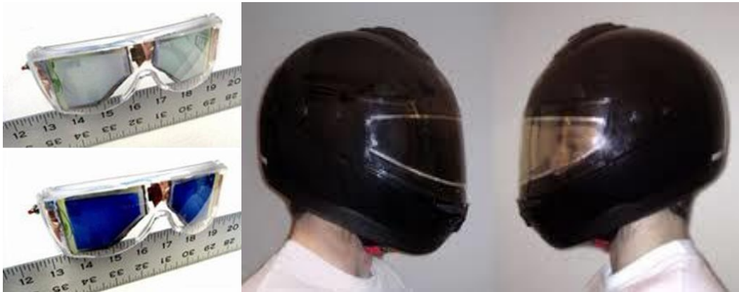
Figures I-17 : (gauche) Lunettes de soleil utilisant un film électrochrome polymère à l'état transparent (haut) et coloré (bas) 69 (droite) Visière électrochrome développée par ChromoGenics
