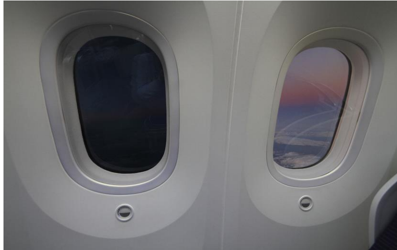
Figure I-14 : Smart windows mises en place dans le Boeing Dreamliner 787 : (état coloré à gauche et transparent à droite)
