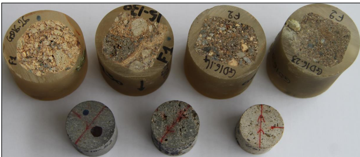
Figure 1-28 - Échantillons de pyroclastites et de matrice de coulée de débris inclus dans une coque cylindrique de résine visqueuse de 40 mm de diamètre (ligne du haut) et carottes de 23 et 25 mm de diamètre.
