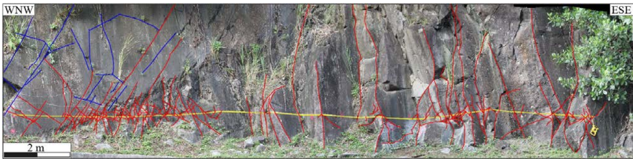
Figure 1-16 – Exemple de scanline réalisée sur une coulée de lave saine sur la route de la traversée de la Basse-Terre. En rouge, sont représentées toutes les fractures mesurées recoupant le profil de mesure (jaune). En bleu, exemples de fractures non prises en compte car elles n'interceptent pas le profil de mesure.
