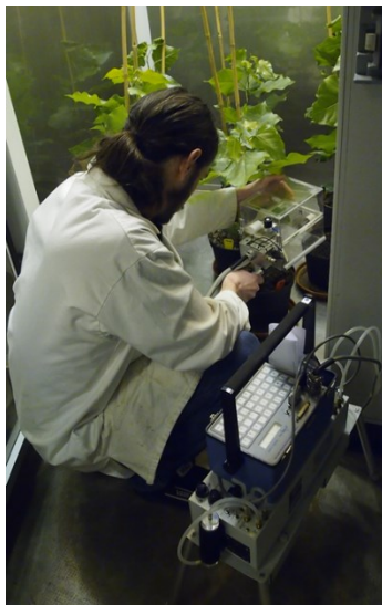
Figure 19 : Mesure de la conductance et de l'assimilation par le Li-Cor 6200 et principe de l'appareil issu du manuel du constructeur.
