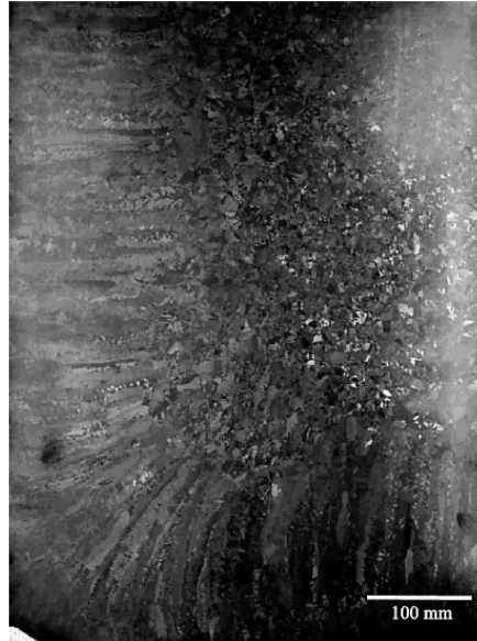
Figure 1-19 Macrographie d'un lingot de 915mm de diamètre montrant les différentes morphologies des grains \beta [72].
