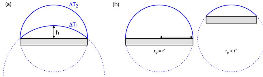
FIGURE I.10 – (a) Evolution de la hauteur de la calotte hémisphérique stable pour deux surfusions où  $\Delta T_1 < \Delta T_2$ . (b) Influence de la taille de particule à une surfusion donnée sur la hauteur de la calotte hémisphérique.
