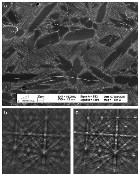
FIGURE III.11 – (a) Microstructure observées en début de formation de la phase  $\alpha$ . Les borures ont la forme de rubans autour desquels la phase  $\alpha$  se forme. (b) et (c) Clichés de Kikuchi du borure métastable (Ti,Nb)B.
