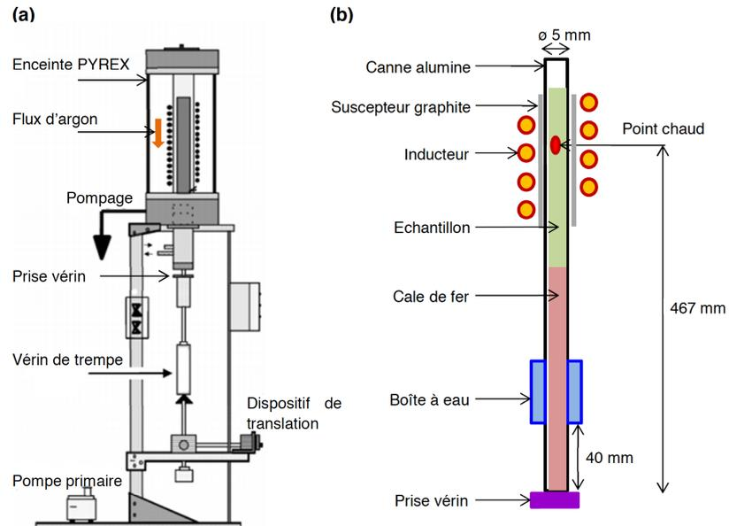
FIGURE II.3 – Schéma du dispositif de TSD de l'IJL : (a) Schéma d'ensemble de la machine, (b) partie supérieure de l'appareil.
