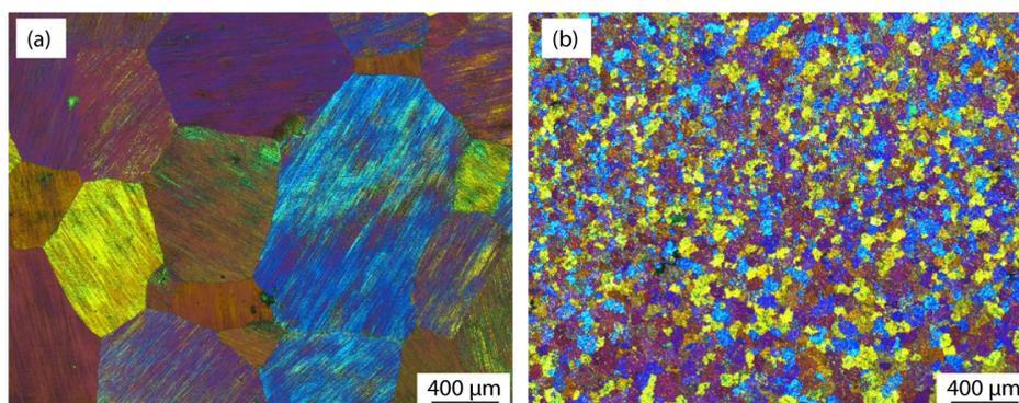
FIGURE III.8 – Microstructures à l'état brut de solidification sur lingots observées en MO avec lumière polarisée sur des alliages (a) Ti-45Al et (b) Ti-45Al-0,5B.
