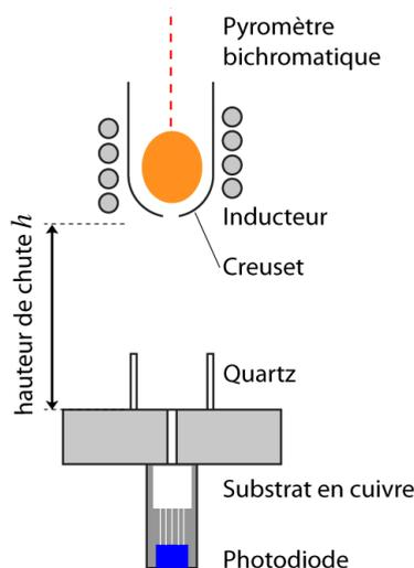
FIGURE II.5 – Schéma du dispositif de chute de goutte.
