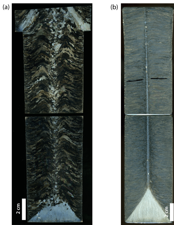
FIGURE III.1 – Macrostructure de lingots obtenus par coulée centrifuge : (a) faible teneur en aluminium, (b) haute teneur en aluminium.
