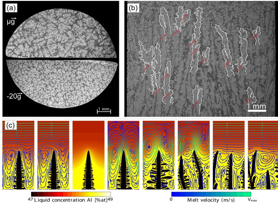
FIGURE III.5 – (a) Coupe radiale d'échantillons élaborés par solidification dirigées en micro- et hyper-gravité. (b) coupe longitudinale de l'échantillon solidifié à  $-20 \vec{g}$ . Les flèches rouges indiquent les événements de tip-splitting. (c) Simulations par la méthode du champ de phase avec prise en compte de la convection induite par la gravité : 15, 5, 0, -1, -3, -5, -10 et  $-20 \vec{g}$  de gauche à droite.
