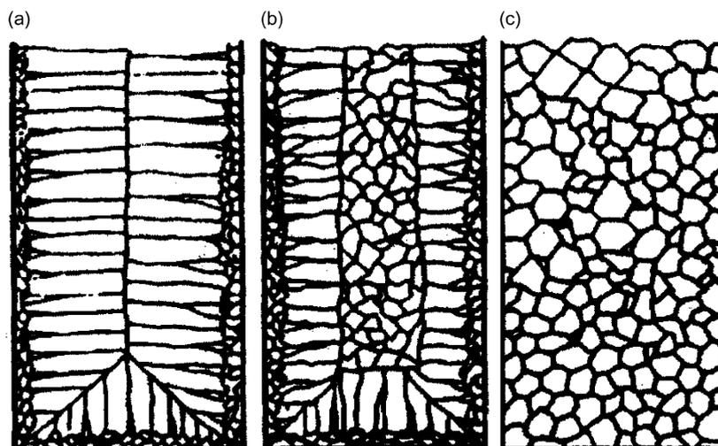
FIGURE I.2 – Structures de grain schématique obtenues après solidification en lingot : (a) zone de peau suivie d'une solidification totalement colonnaire, (b) comme (a) sauf qu'une transition colonnaire-équiaxe a lieu en fin de solidification, (c) structure totalement équiaxe [3].
