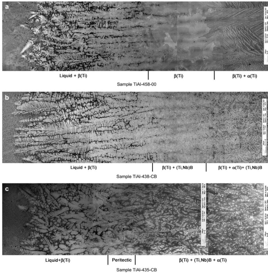
FIGURE III.9 – Aperçu des microstructures issues de solidification dirigée, observées en images MEB-BSE sur coupe longitudinale pour 3 alliages : (a) Ti-45Al-8Nb, (b) Ti-43Al-8Nb-0,2C-0,2B et (c) Ti-43Al-5Nb-0,2C-0,2B.
