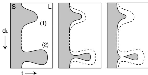
FIGURE I.12 – Représentation schématique de la refusion (1) et de la fragmentation (2) de bras dendritiques secondaires [8].
