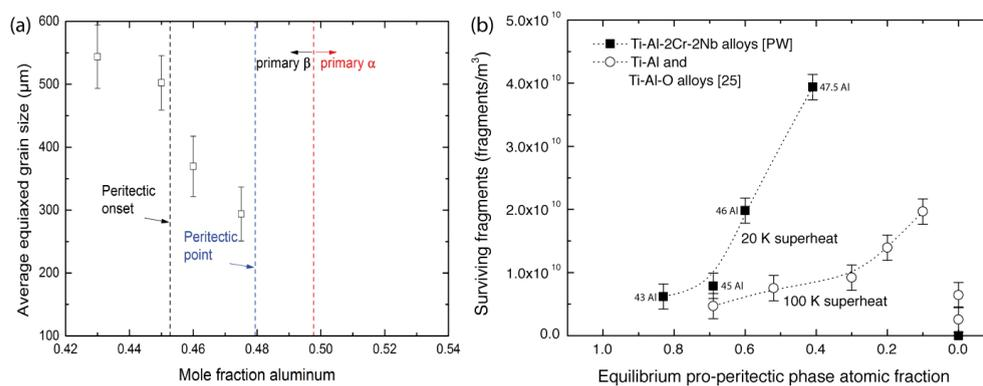
FIGURE III.3 – (a) évolution de la taille de grains équiaxes en fonction de la teneur en aluminium et (b) évolution du nombre de fragments estimés en fonction de la quantité de phase pro-péritectique comparée aux données de [10].
