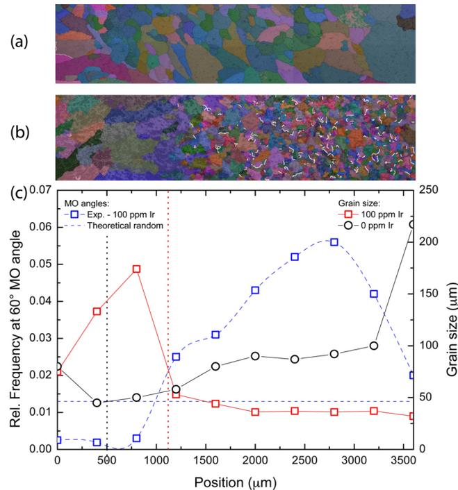
FIGURE III.19 – (a) Carte EBSD en fausses couleurs des échantillons (a) sans Ir, (b) avec 100 ppm d'Ir. Dans (c), les tailles obtenues déduites de (a) et (b) sont tracées en fonction de la distance au substrat de cuivre. Le taux de joints de grains maclés pour l'échantillon avec Ir est indiqué. Les traits pointillés verticaux indiquent la position de la TCE dans l'échantillon (a) en noire et (b) en rouge. La ligne pointillée horizontale correspond au taux de maclés prédit par Mackenzie [12].
