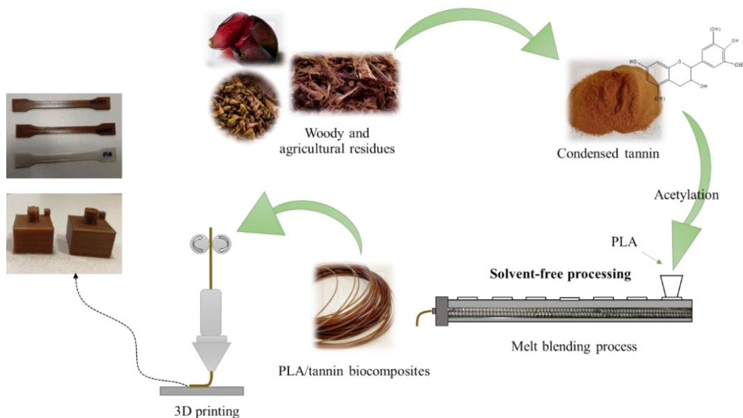
Figure 0-5. Préparation de filaments PLA/AT par mélange en voie fondue par un procédé d'extrusion et procédé d'impression 3D par dépôt de fil fondu.
