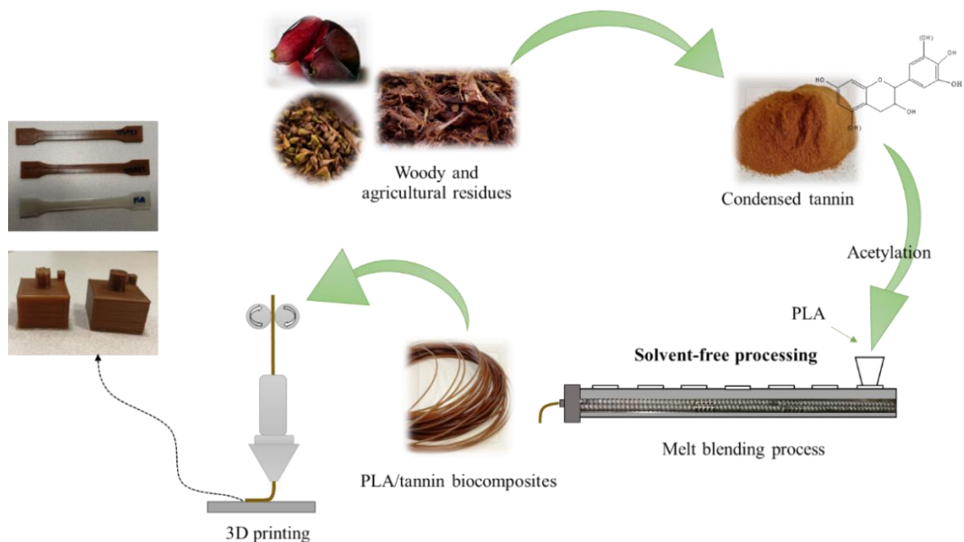
Figure 0-5. Préparation de filaments PLA/AT par mélange en voie fondue par un procédé d'extrusion et procédé d'impression 3D par dépôt de fil fondu.
