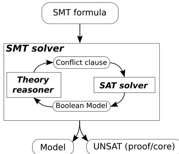
FIGURE 2.4 – Architecture d'un SMT solver
