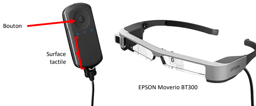
Fig. 3. 12. Exemple de surface tactile connecté à des lunettes électroniques.
