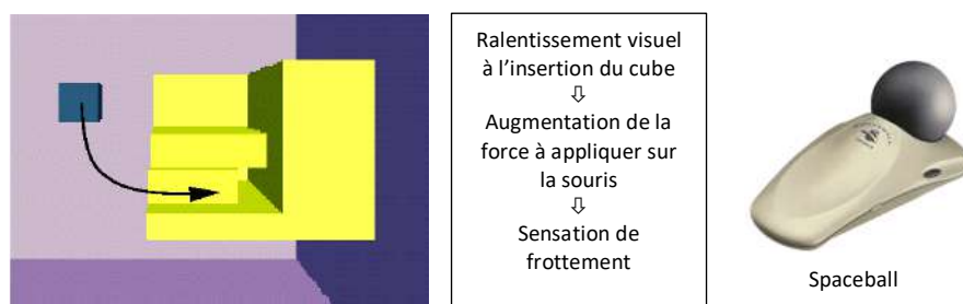
Fig. 1. 4. Exemple de retour pseudo-haptique avec une souris isométrique [4].
