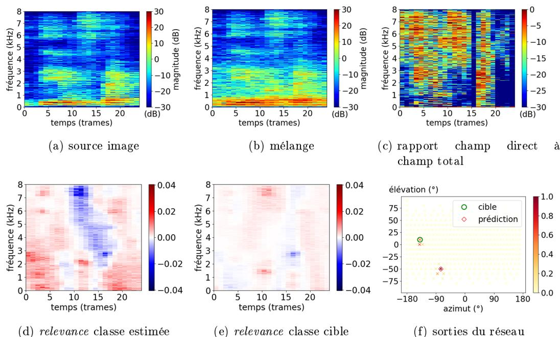
FIGURE 4.15. – LRP pour un signal contenant une source ponctuelle venant de  $(-141^\circ, 8^\circ)$  et du bruit de foule diffus à 2 dB SNR, avec  $TR60 = 688$  ms. Spectrogrammes (a) de l’image spatiale de la source et (b) du mélange. (c) Rapport champ direct à champ total. (f) Estimation du réseau. (d) *Relevance* sommée sur tous les canaux pour la classe estimée et (e) pour la classe cible.
