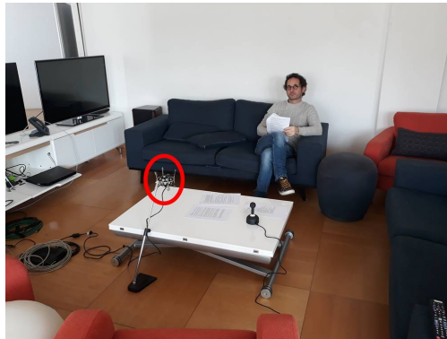
FIGURE 4.5. – Configuration d'enregistrement réel dans un salon. L'Eigenmike utilisé pour la capture est entouré en rouge.
