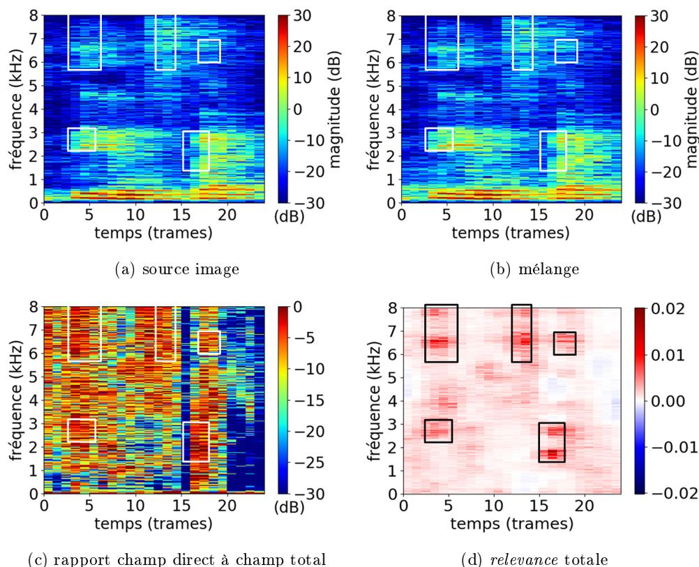
FIGURE 4.13. – LRP pour un signal contenant une source ponctuelle venant de  $(139^\circ, -61^\circ)$  et du bruit de foule diffus à 18 dB SNR, avec  $TR_{60} = 772$  ms. Spectrogrammes (a) de l'image spatiale de la source (c) et du mélange. (c) Rapport champ direct à champ total. (d) *Relevance* sommée sur tous les canaux. Le détail des paramètres d'entrée (vecteur d'intensité actif et réactif pour chaque canal) et des *relevances* par canal est présenté en Annexes A et C.
