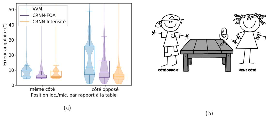
FIGURE 4.9. – (a) Performances de localisation des différents systèmes sur les enregistrements réels contenant une seule source en fonction du côté de la table où elle est située. (b) Représentation de la situation où la source est du même côté de la table que le microphone et de la situation où elle est du côté opposé.
