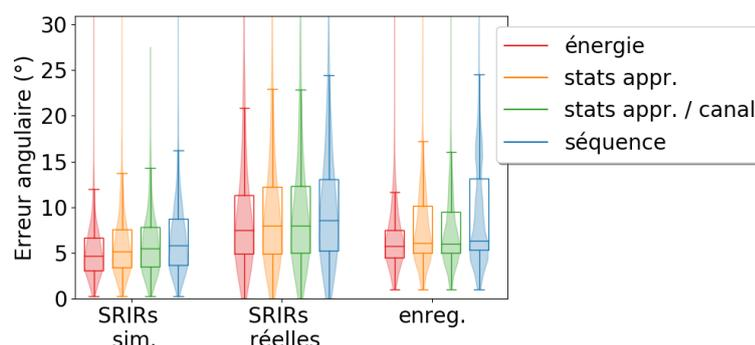
FIGURE 4.20. – Performances de localisation du CRNN-Intensité appris avec différentes normalisations de la paramétrisation d’entrée, sur les ensembles de test à une seule source.
