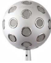
FIGURE 2.3. – Antenne de microphones Eigenmike, par Mh Acoustics [10]. Elle comporte 32 capsules réparties quasi-uniformément sur une sphère de 8,4 cm de diamètre, permettant un encodage HOA jusqu'à l'ordre 4.
