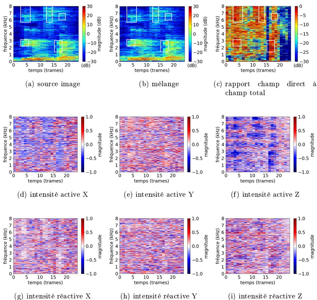
FIGURE A.1. – Exemple de paramétrisation selon (4.5) d'un signal contenant une source ponctuelle venant de  $(139^\circ, -61^\circ)$  et du bruit de foule à 18 dB SNR. (a) spectrogramme de l'image spatiale de la source. (b) spectrogramme du mélange. (c) Rapport champ direct à champ total. (d), (e) et (f) : vecteur d'intensité active normalisé. (g), (h) et (i) : vecteur d'intensité réactive normalisé.
