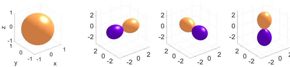
FIGURE 2.2. – Directivité  $\|\tilde{Y}_{nm}^\sigma(\theta, \phi)\|^2$  des harmoniques sphériques correspondant aux canaux ambisoniques  $W$ ,  $X$ ,  $Y$  et  $Z$ . Les zones orange (claires) indiquent une grandeur positive et les violettes (plus foncées) une grandeur négative.
