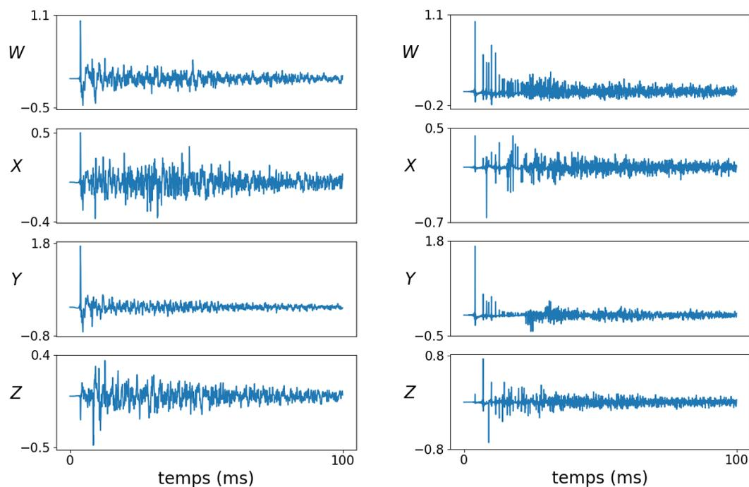
FIGURE 4.3. – Comparaison entre une SRIR FOA réelle (gauche) et simulée (droite). La SRIR réelle correspond à une source située à  $(71^\circ, -5^\circ)$  et la SRIR simulée à une source située à  $(77^\circ, 5^\circ)$ . Les salles sont, de fait, différentes.
