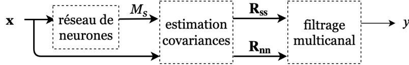
FIGURE 3.4. – Filtrage multicanal utilisant des masques temps-fréquence estimés par un réseau de neurones.
