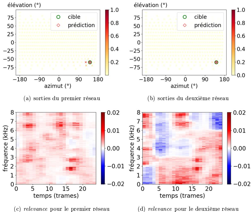
FIGURE 4.18. – LRP pour un signal contenant une source ponctuelle venant de  $(139^\circ, -61^\circ)$  et du bruit de foule diffus à 18 dB SNR, avec  $TR_{60} = 772$  ms, comme dans la Figure 4.13. (a) et (b) : estimations des deux réseaux. (c) et (d) *Relevances* pour la classe estimée pour les deux réseaux.
