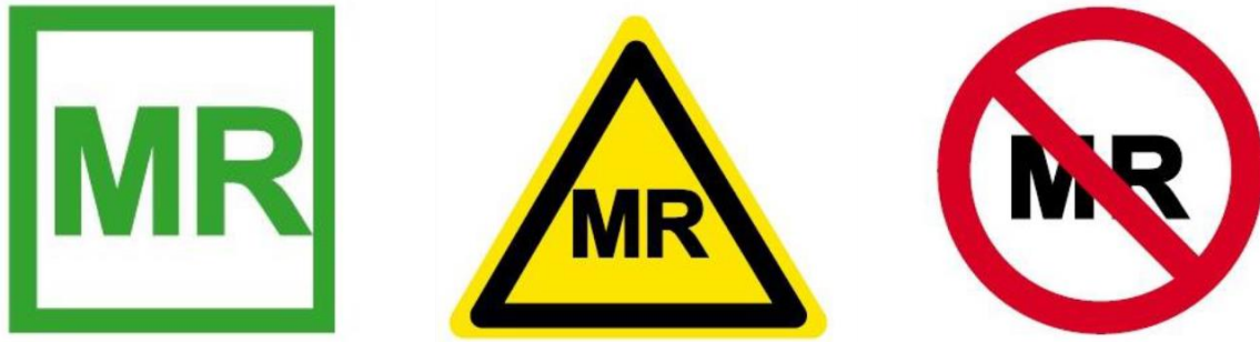
Figure I-20 : Symboles identifiant le type de compatibilité des appareils selon la norme IEC 60601-2-33 [10]. De gauche à droite MR safe, MR conditional et MR unsable.
