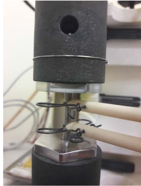
(b) Éprouvette et extensomètre à couteaux
