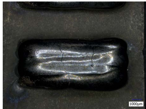
(b) Fissures transverses débouchantes (P, V, D) = (900 W, 1000 mm/min, 4,8 g/min)
