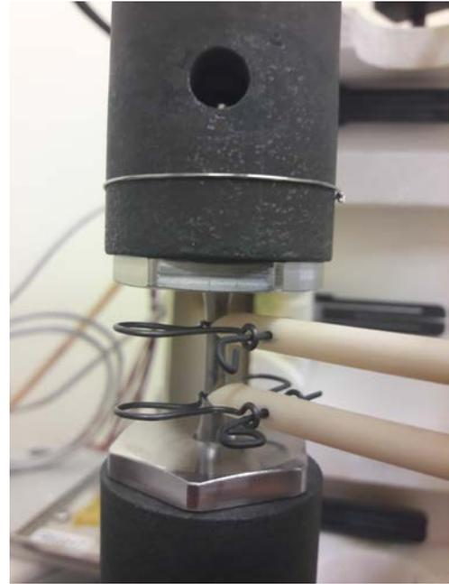
(b) Éprouvette et extensomètre à couteaux
