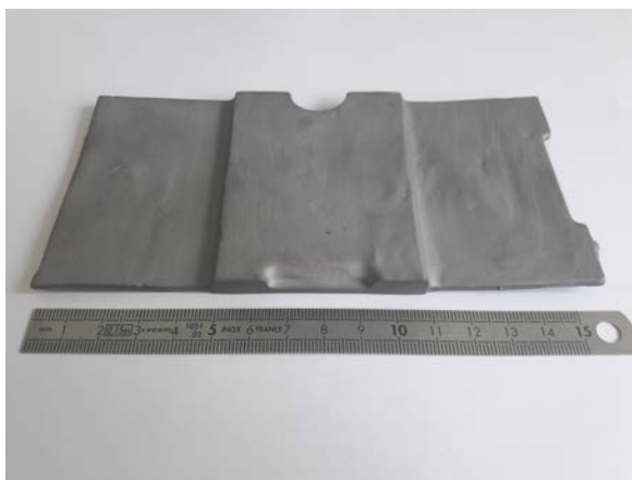
(a) Plaque en IN738 LC après mise en solution
