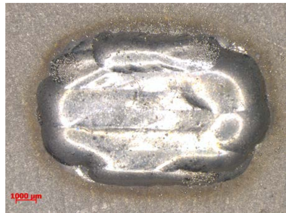
(b) Rechargement d'une petite cuvette
