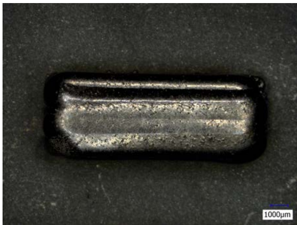
(a) Pas de fissures débouchantes (P, V, D) = (440 W, 300 mm/min, 1,8 g/min)
