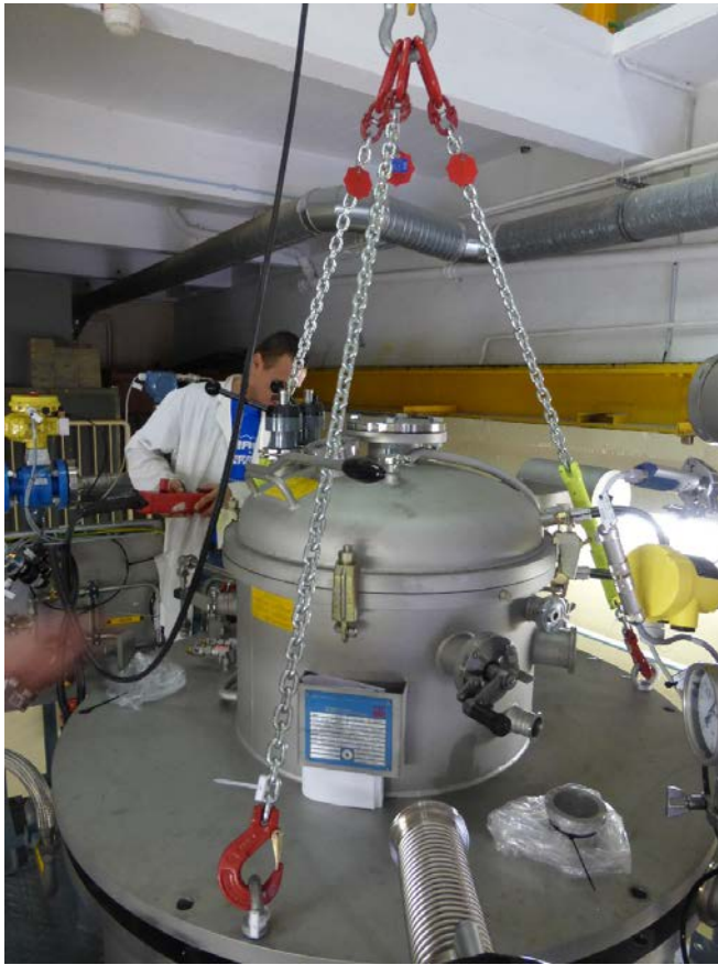
(a) Tour d'atomisation de l'ONERA ALD Vacuum Technologies GmbH
