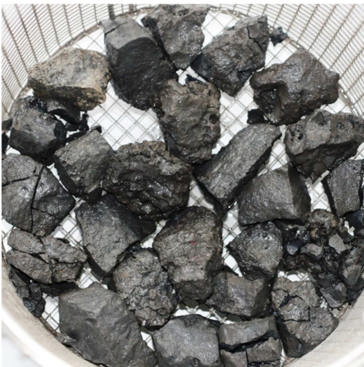
a) Dégradation par fragmentation des grains (grains généralement compacts)
