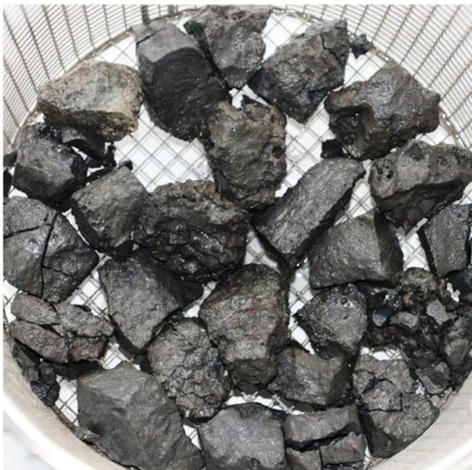
a) Dégradation par fragmentation des grains
