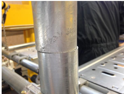
Fig. IV.25. Jeux d'assemblages maximales observés
