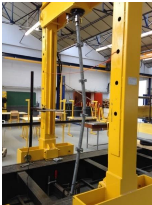
Fig. IV.5. Déformation finale d'une barre à la ruine
