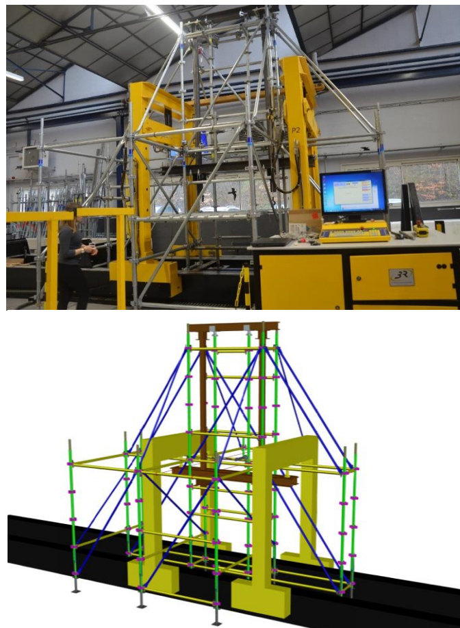
Fig. IV.14. Dispositif d'essai en vraie grandeur pour les essais sur les échelles d'échafaudage
