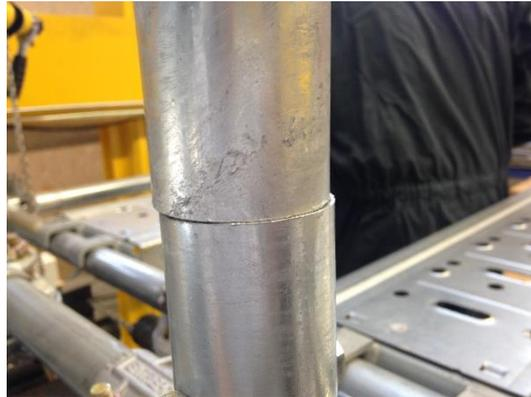
Fig. IV.25. Jeux d'assemblages maximales observés
