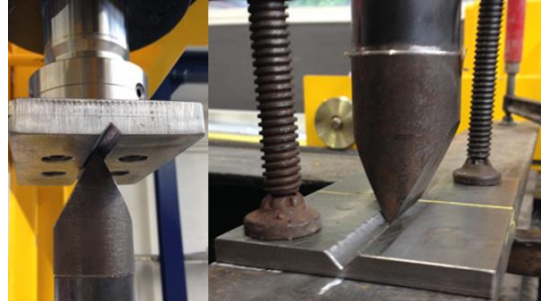
Fig. IV.2. Dispositif d'appuis : appuis tournevis
