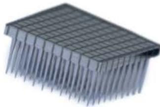
FIGURE 1.15 – Matrice de micro-électrodes - MEA. Illustration extraite du site de BlackRock Systems.
