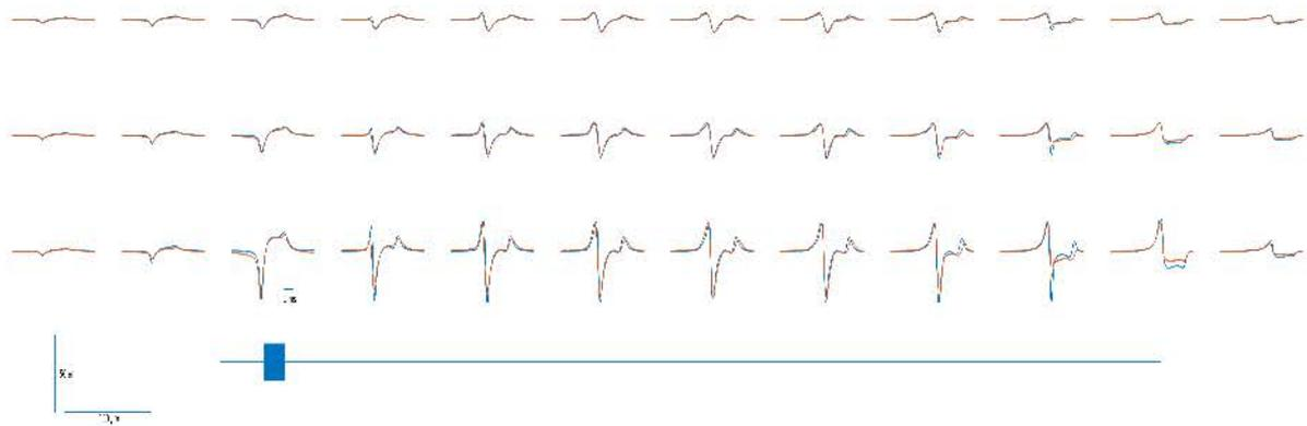
FIGURE 3.12 – Formes des EAPs en fonction de la position de l'électrode pour une morphologie donnée  $L_A = 1000\mu\text{m}$ ,  $\Phi_A = 2\mu\text{m}$ ,  $L_D = 50\mu\text{m}$ ,  $\Phi_D = 2\mu\text{m}$ . Les courbes rouges correspondent au modèle compartimental (LFPy+NEURON) tandis que les courbes bleues sont calculées avec le filtrage morphologique. Notez que toutes les positions des électrodes ne sont pas toutes représentées.
