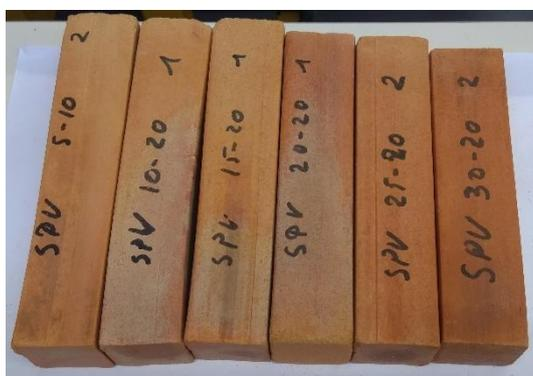
Figure 3.88 : Aspect visuel des blocs « SPV » d'argile cuite de Sèmè-Podji avec ajout de verres broyés
