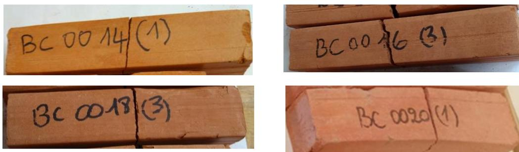
Figure 3.24 : Mode de rupture à la traction par flexion trois points des blocs « B » d'argile cuite de Zogbodomey sans ajout
