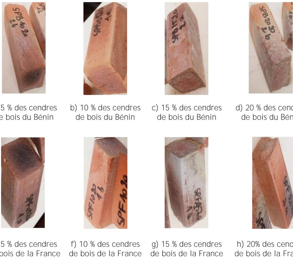
Figure 3.44 : Aspect du cœur des blocs cuits d'argile de Sèmè-Podji avec ajout des cendres de bois
