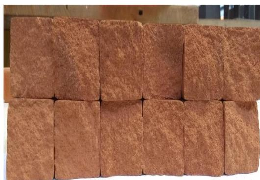
Figure 3.89 : Aspect du cœur des blocs « SPV » d'argile cuite de Sèmè-Podji avec ajout de verres broyés
