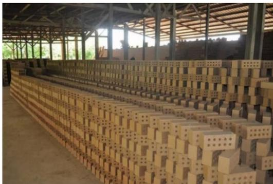
Figure 1.14 : Séchage dans un hangar à Zogbodomey au Bénin (Source : Nature Brique)
