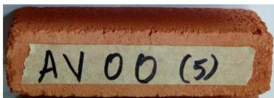
Figure 3.12 : Aspect visuel d'un bloc cuit d'argile de Zogbodomey sans ajout, ayant subi le compactage horizontal
