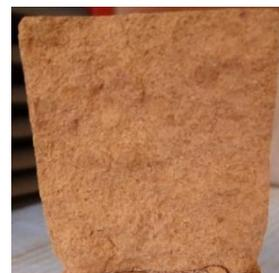
Figure 3.13 : Aspect du cœur d'un bloc cuit d'argile de Zogbodomey sans ajout, ayant subi le compactage horizontal
