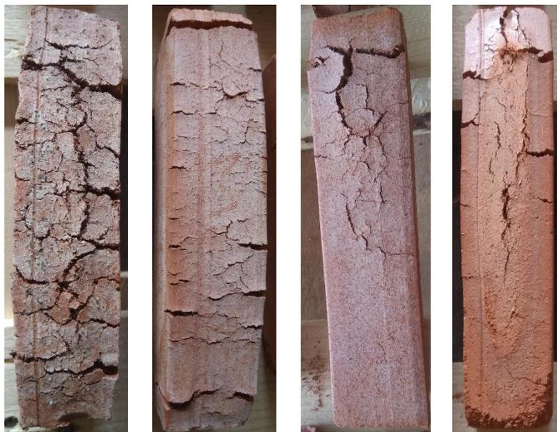
Figure 3.87 : Aspect visuel des blocs d'argile cuits de Xeuilley avec ajout de verres broyés
