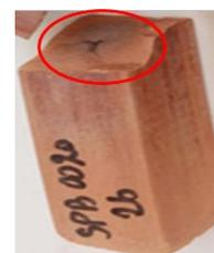
Figure 3.11 : Aspect du cœur des blocs d'argile de Sèmè-Podji sans ajout
