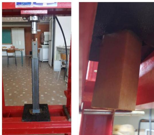
Figure 2.28 : Presse manuelle hydraulique de compactage
