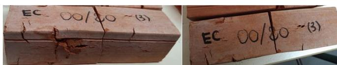
Figure 3.6 : Aspect visuel des blocs d'argile de Xeuilley sans ajout après cuisson
