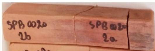
Figure 3.10 : Mode de rupture à la traction par flexion trois points, des blocs d'argile de Sèmè-Podji sans ajout
