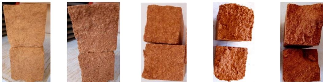
Figure 3.97 : Aspect du cœur des blocs « AV » d'argile cuite de Zogbodomey avec ajout de verres broyés
