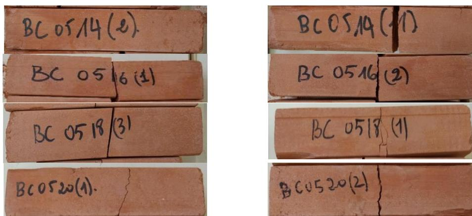
Figure 3.78 : Mode de rupture à la traction par flexion trois points des blocs d'argile de Zogbodomey avec ajout de 5% de cendres de bois, ayant subi le compactage vertical
