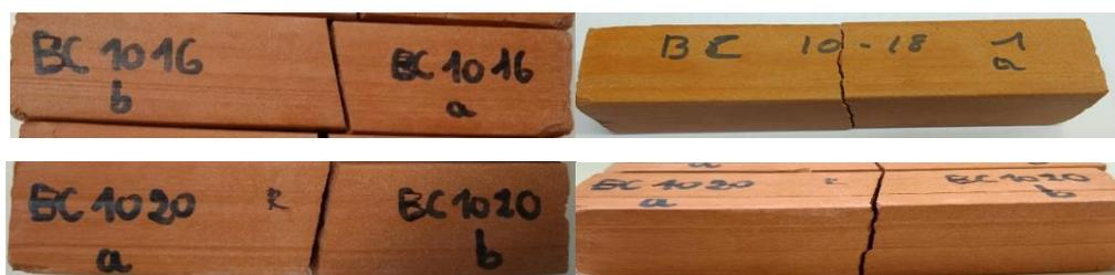
Figure 3.79 : Mode de rupture à la traction par flexion trois points des blocs d'argile de Zogbodomey avec ajout de 10% de cendres de bois, ayant subi le compactage vertical
