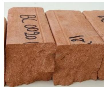
Figure 3.17 : Aspect du cœur des blocs « B » d'argile de Zogbodomey sans ajout
