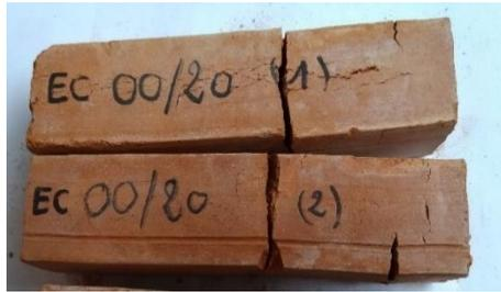
Figure 3.7 : Mode de rupture des blocs d'argile de Xeuilley sans ajout à la traction par flexion trois points
