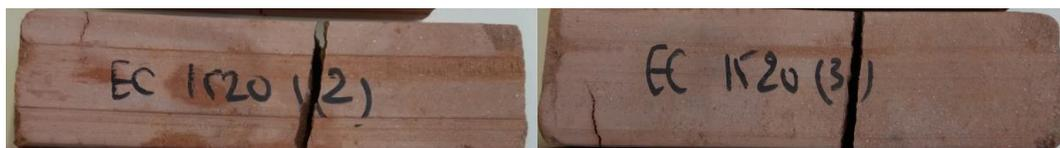
Figure 3.39 : Mode de rupture des blocs d'argile cuits de Xeuilley avec ajout de 15% des cendres de bois de la France
