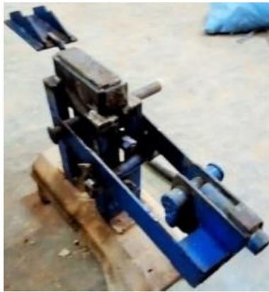
Figure 2.26 : Presse manuelle mécanique de compactage
