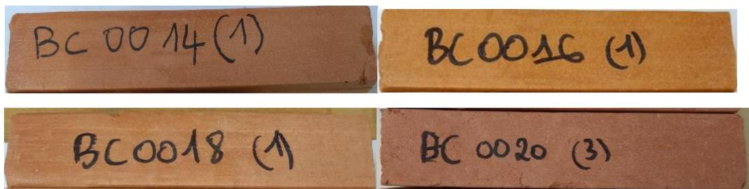
Figure 3.16 : Aspect visuel des blocs « B » d'argile cuite de Zogbodomey sans ajout
