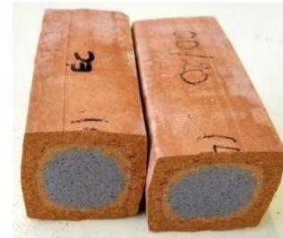
Figure 3.8 : Aspect du cœur des blocs d'argile de Xeuilley sans ajout
