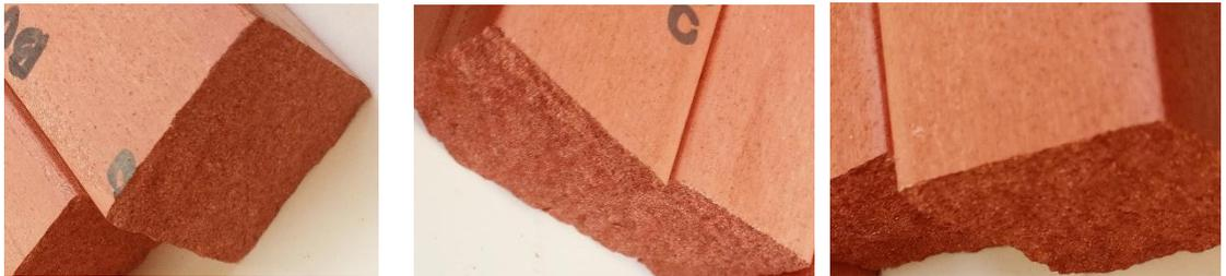
Figure 3.105 : Aspect du cœur des blocs « BV » d'argile cuite de Zogbodomey avec ajout de verres broyés
