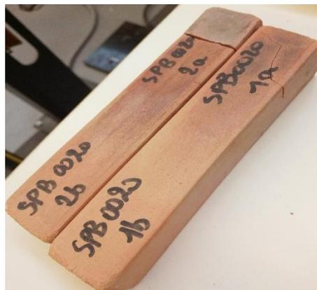
Figure 3.9 : Aspect visuel des blocs d'argile de Sèmè-Podji sans ajout après cuisson
