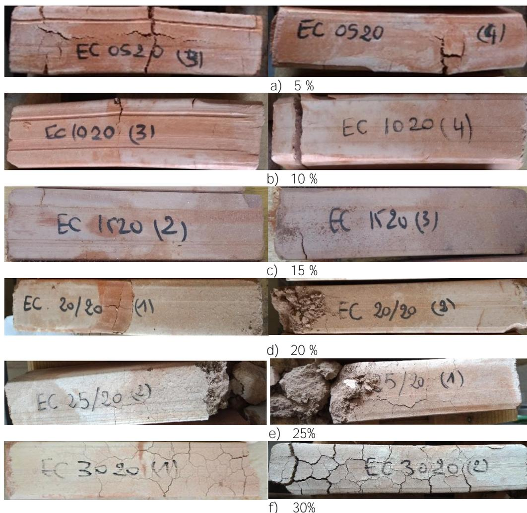
Figure 3.31 : Aspect visuel de blocs cuits d'argile de Xeuilley avec ajout de cendres de bois de la France
