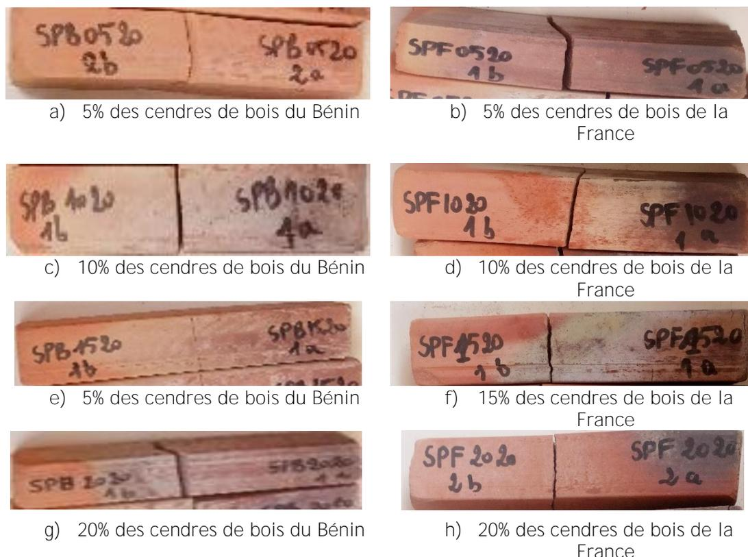
Figure 3.52 : Mode de rupture des blocs cuits d'argile de Sèmè-Podji avec ajout des cendres de bois
