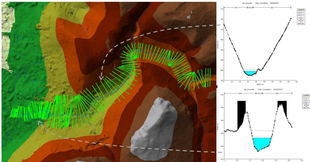
Le site de Zaouit Echiekh est modélisé sur un tronçon de 1570m pour un dénivelé du thalweg de 65 m. Ce tronçon traverse toute la localité et englobe le site de mesure des débits. Il est de nature plus simple à modéliser que celui de Sidi Chami car le chenal, plus profond est mieux marqué.
