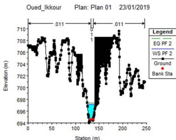
Le changement brutal de direction vers la gauche au PKH 568 m génère également un fort ralentissement de l'écoulement, qui passe de 4 m/s à 2,5 m/s ainsi qu'une augmentation de la
