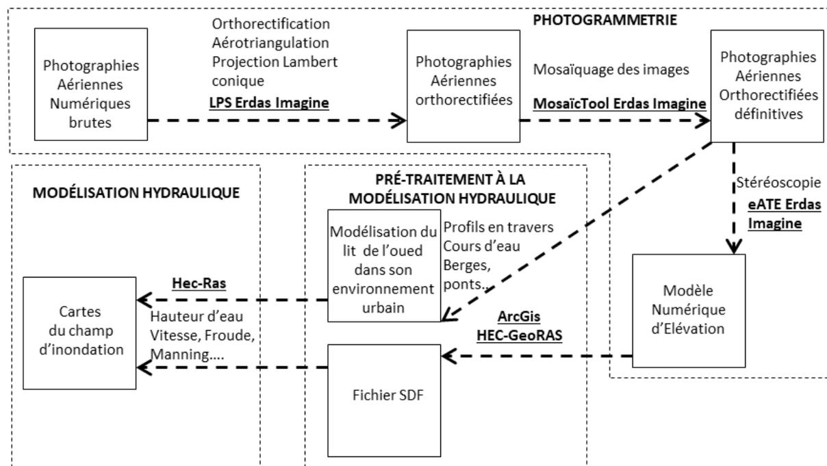
Sur la base de l'emprise choisie, l'étape de pré-modélisation a consisté à produire les profils en travers perpendiculaire au cours d'eau, à renseigner les infrastructures (bâtiments, ponts etc...), les coefficients de rugosités et leur domaine d'application (limite des lit mineur et majeur)
