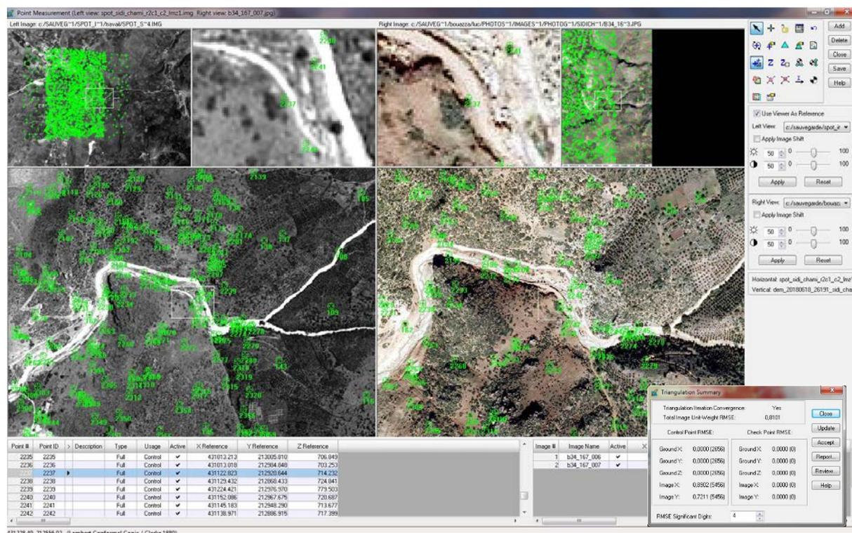
La troisième étape est la définition géométrique du modèle hydraulique dans le logiciel ArcGis en utilisant l'extension "HEC-GeoRAS": délimitation des bâtiments, définition des profils en travers (fig. 7.3 et 7.4). Cette étape consiste en la description d'un squelette définissant la géométrie du domaine de la simulation numérique du modèle, à partir de profils topographiques tirés du MNS, de la connaissance a priori des limites entre lit mineur/majeur ainsi que de l'emprise des bâtiments.
