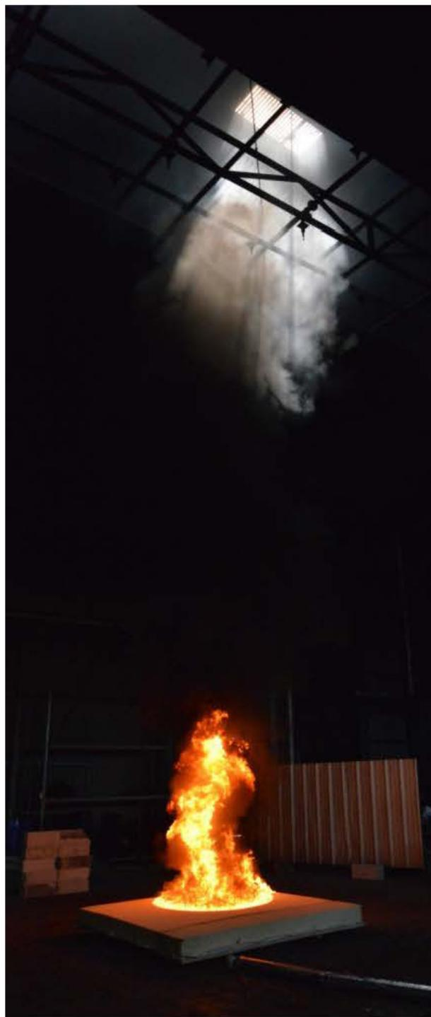
FIGURE 3.6 – Aperçu d'un essai mousse polyuréthane de 6 m<sup>2</sup> sur le site du CNPP.
