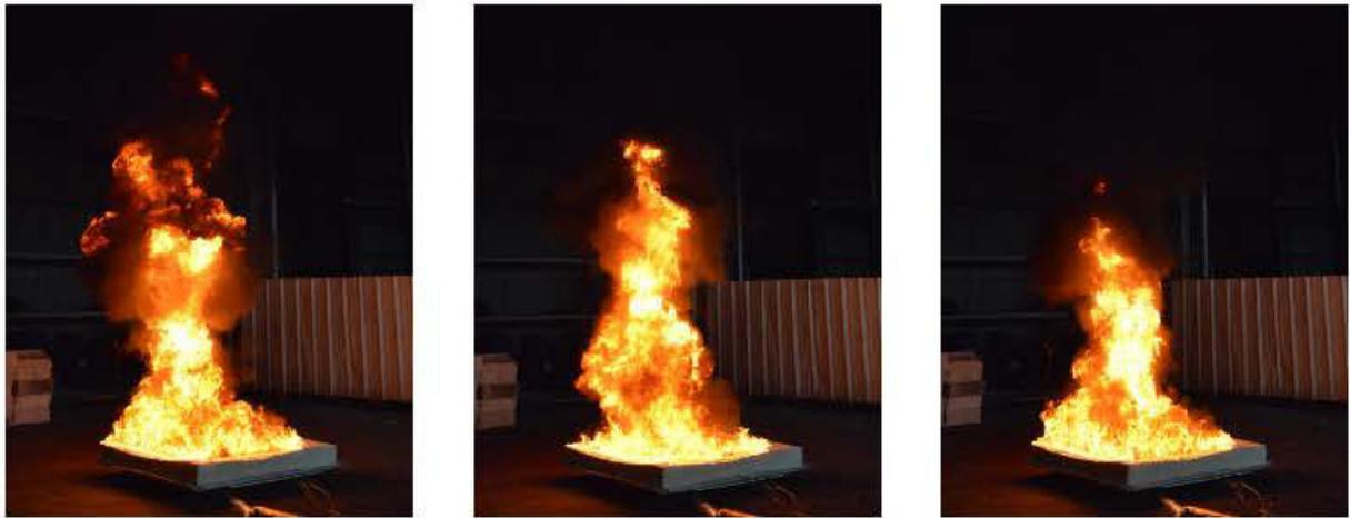
FIGURE 5.15 – Aperçu d’un essai mousse polyuréthane de 3 m<sup>2</sup> sur le site du CNPP.
