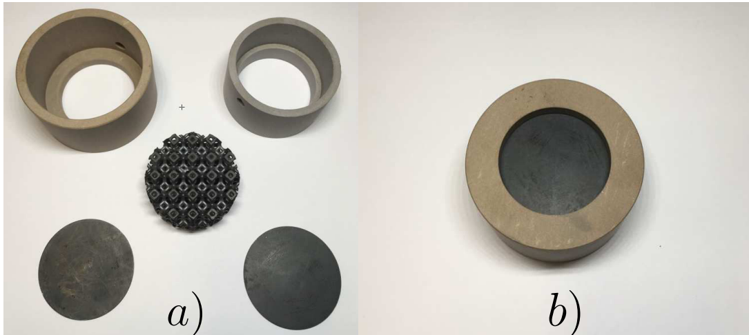
FIGURE 3.10 – Système (support, semelles et échantillon) a) démonté b) assemblé
