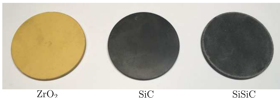
FIGURE 3.18 – Disques massifs de trois céramiques respectivement : Zircone, Carbure de Silicium et Carbure de Silicium infiltré
