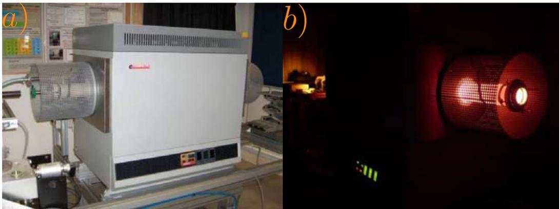
FIGURE 3.8 – Four tubulaire haute température [109] : a) à température ambiante b) à haute température
