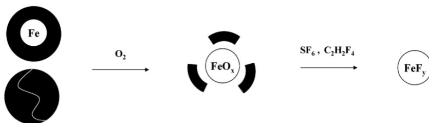
Figure I.18 : Mécanisme d'oxydation du fer et de désactivation des oxydes par des composés fluorés 110
