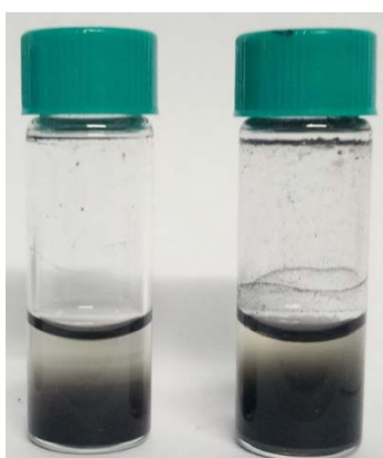
Figure V. 11 : Dispersion dans l'eau de FLG (à gauche) et de FLG fonctionnalisé (hydrazine, reflux 48h) (à droite)
