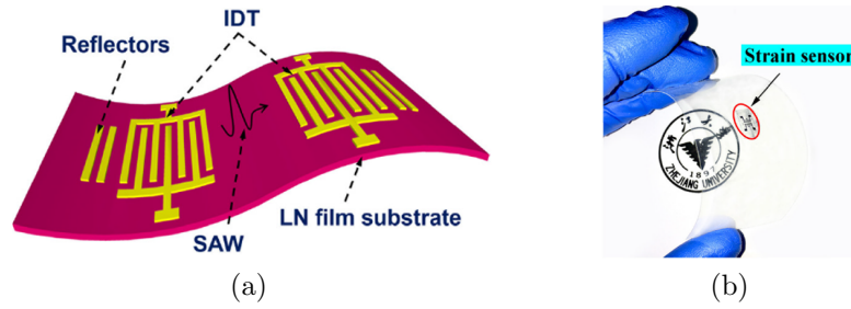
FIGURE 1.27 – SAW flexible sur \text{LiNbO}_3 aminci : (a) Représentation schématique (b) Réalisation expérimentale [140]
