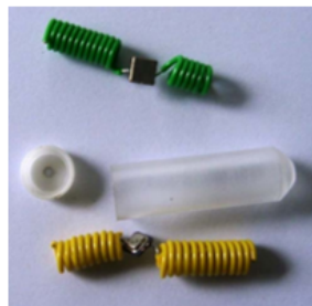
FIGURE 4.3 – Exemple d'un capteur de température ingérable basé sur le principe SAW [212]
