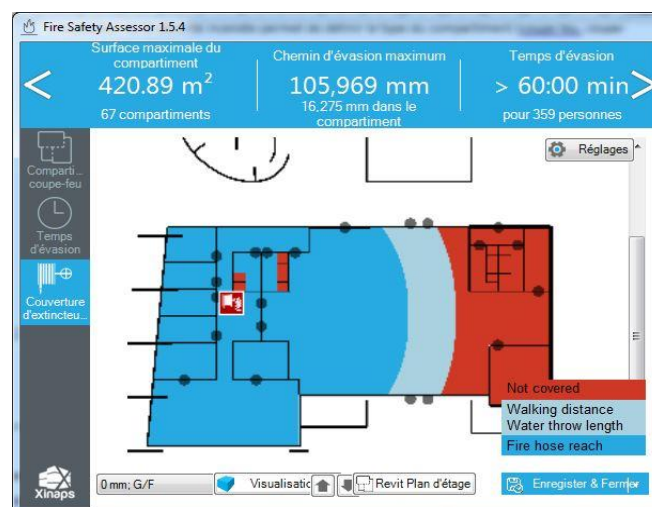
Figure 16 Capture d'écran de la fenêtre volante de l'évaluateur de sécurité incendie de Xinaps, résultats du calcul du parcours de secours.
