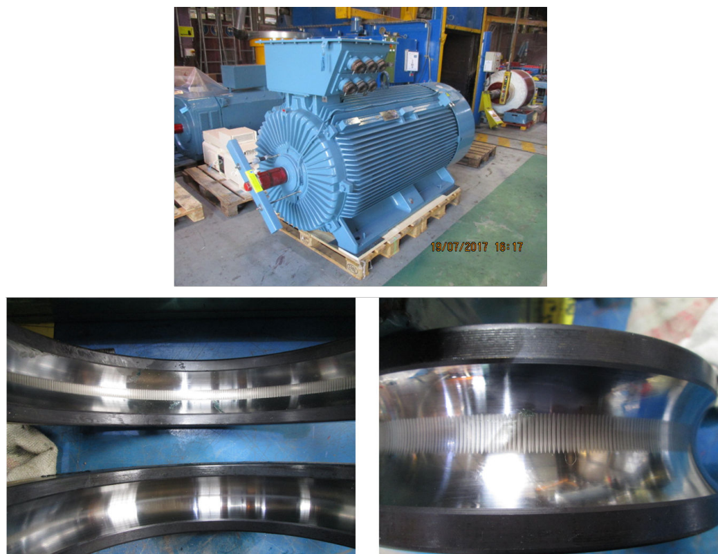
FIGURE 1.4.19 – Défaut de fluting avancé sur un roulement 6326 C3, moteur 900 kW - 660 V, bague externe (zone de charge en haut à gauche), bague interne (à droite). Source : LORELEC, inspection visuelle
