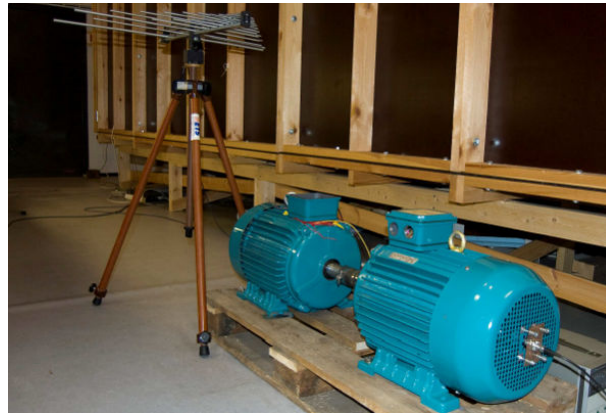
FIGURE 1.3.13 – Banc d'essai réalisant une détection radio-fréquence des décharges capacitives dans les roulements, Särkimäki (2009)
