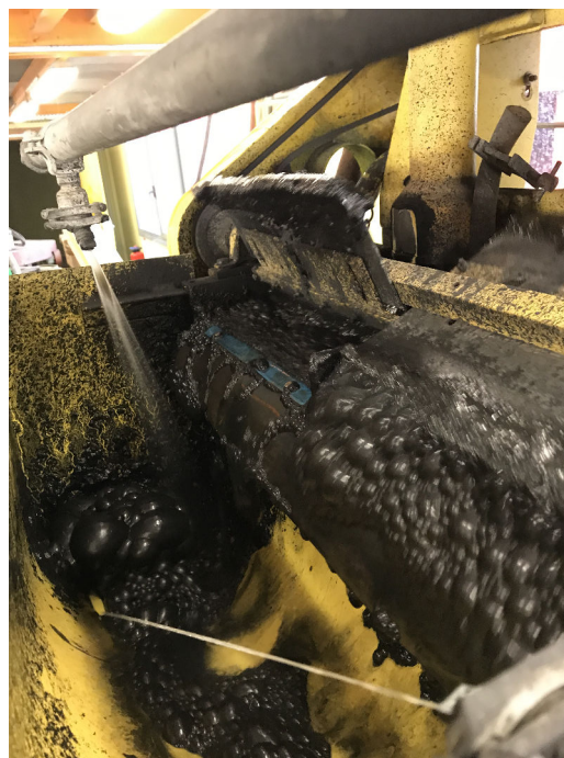
Fig. 4 – Mousse de l'étape de dégrossissage de l'essai de flottation pilote.
