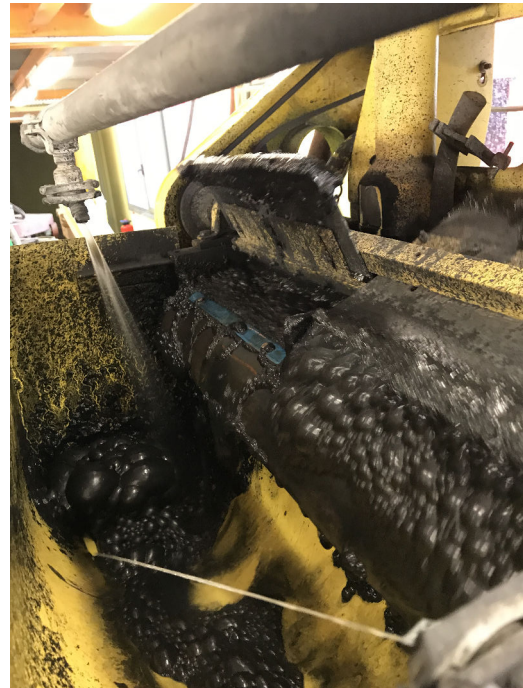
Fig. 4 – Mousse de l'étape de dégrossissage de l'essai de flottation pilote.
