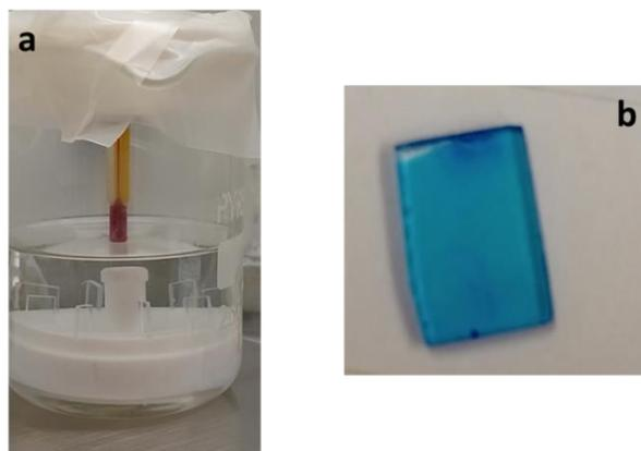
**Figure 70 :** Photographies (a) des plaques de verre immergées dans la solution pendant l'étape de croissance des films de silice. (b) Film SiO<sub>2</sub>-BM d'aspect homogène et de couleur bleu clair.
