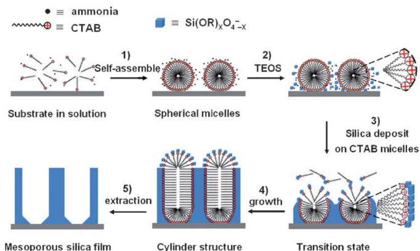
Figure 69 : illustration du processus de formation de couches de silice à mésopores perpendiculairement orientés, déposés sur un substrat via la procédure de croissance spontanée de Stöber [139].
