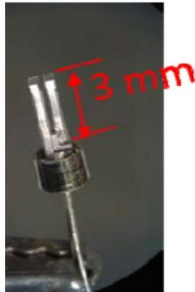
**Figure 7 :** Image photographique d'un capteur QTF [69].
