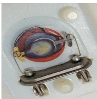
Figure 22 : Photographie du film de PANI-EB déposé par spin-coating sur un cristal piézoélectrique activé par une solution de Piranha.
