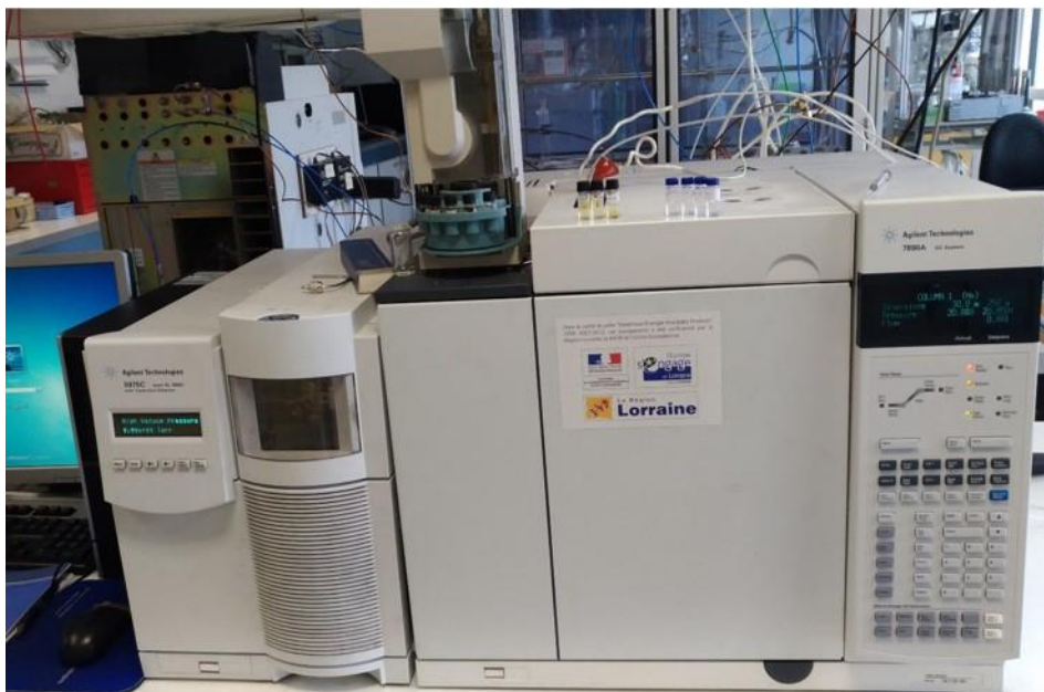
Figure II. 8: Chromatographie en phase gazeuse couplée à la spectrométrie de masse et un détecteur à ionisation de flamme (GC/MS-FID).
