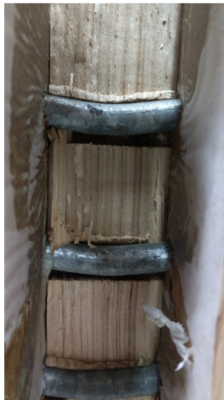
Essais Bois/Bois - D12 Partie centrale d'un mode 3
