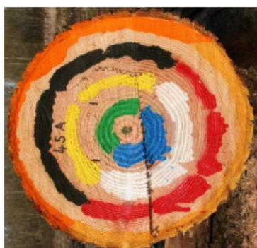
Figure 2-1 : Codes couleurs utilisés pour la graduation de la distance par rapport à la moelle et exemple de marquage.
