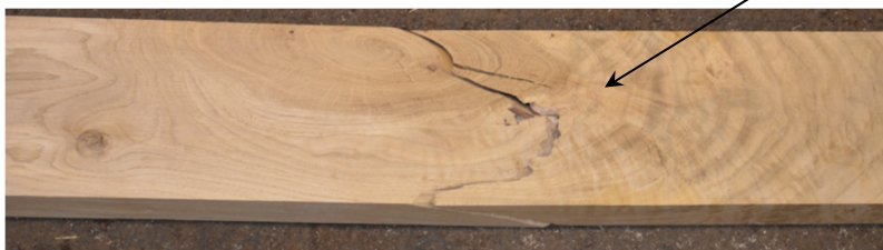
Figure 3-29 : Comportement expérimental en traction axiale.
