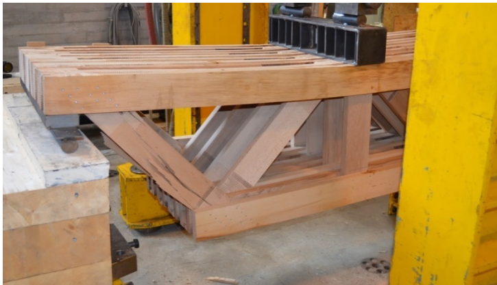
Poutre treillis « picots » testées
