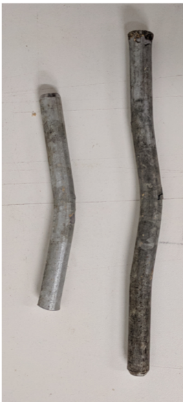
Essais Bois/Bois - D12 Mode 2 (gauche) Mode 3 (droite)
