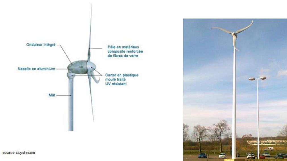
**Figure 48.** Description de la micro-éolienne Skystream.
