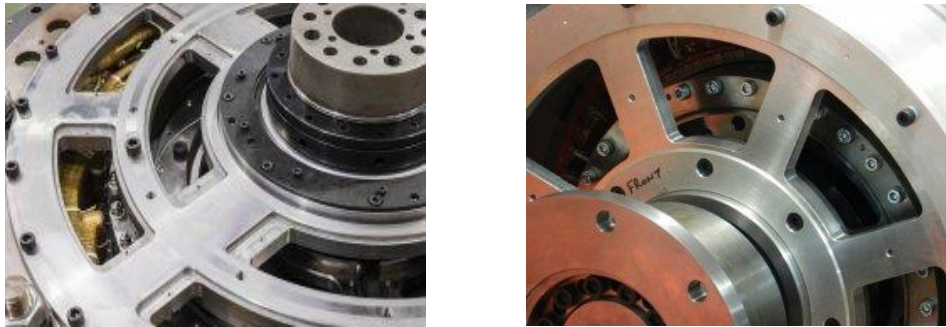
Figure I-54 : Machine à aimants intégrant un engrenage magnétique PDD pour la propulsion marine.
