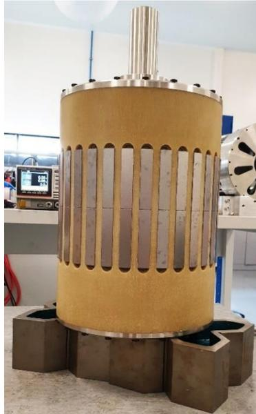
*Figure IV-14 : Rotor basse vitesse avec les pièces SMC.*
