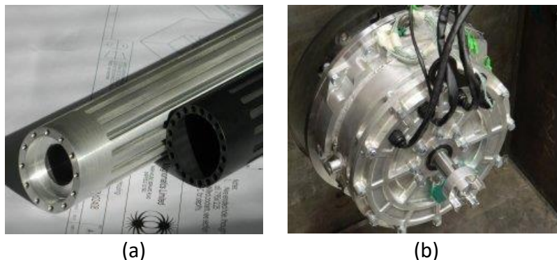
Figure I-53 : (a) Composants d'engrenage, (b) Engrenage magnétique à transmission variable MAGSPLIT.
