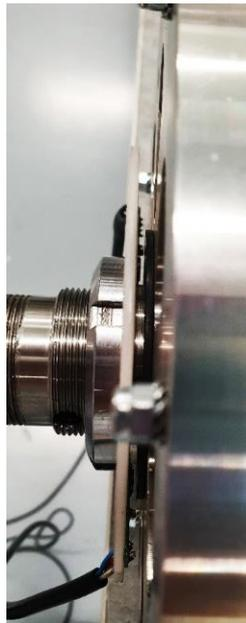
*Figure IV-13 : Capteur de vitesse placé sur la machine.*
