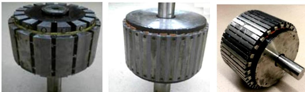
Figure I-33 : Prototype d'un engrenage magnétique à concentration de flux [UPP14].
