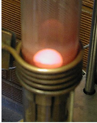
Figure II-1 : Boulet dans le four à induction haute fréquence.
