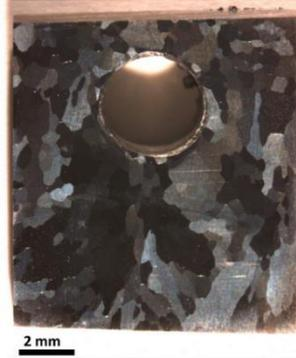
*Figure II-3 : Echantillon sous forme de plaquette attaqué chimiquement*
