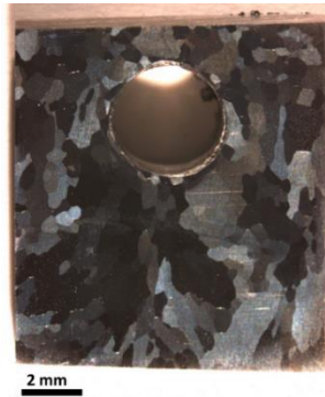
Figure II-3 : Echantillon sous forme de plaquette attaqué chimiquement
