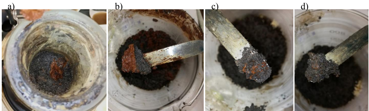
Figure 86 - Photographie du démantèlement d'une Col-S-COK-Fe, a) les trois premiers centimètres au-dessus du cône bas, vue du dessus, b) scission entre première couche colmatée de précipités ferriques et terre tassée au-dessus, c) et d) amas de particules ferriques collectées de façon hétérogène dans les cinq premiers centimètres de la colonne, chemins préférentiels dans le lit de terre.
