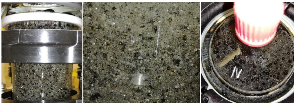
Figure 61 - Photographie d'une colonne de billes de verre après Drainage - Imbibition, corps de colonne (gauche et milieu), ou vue du dessus du cône haut (droite)
