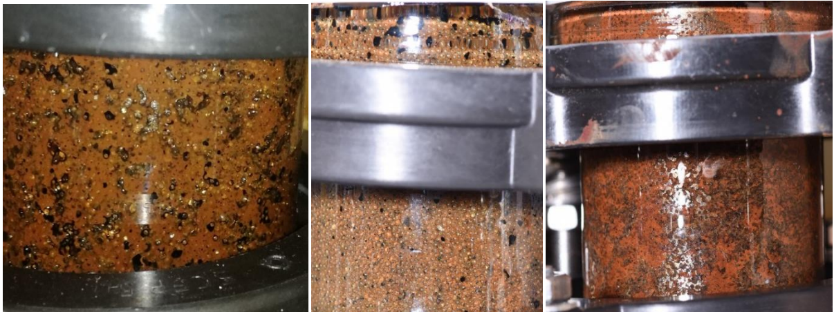
Figure 66 - Photographies des corps de colonne (billes de verre) au cours (gauche) et après (milieu et droite) traitement par les ferrates
