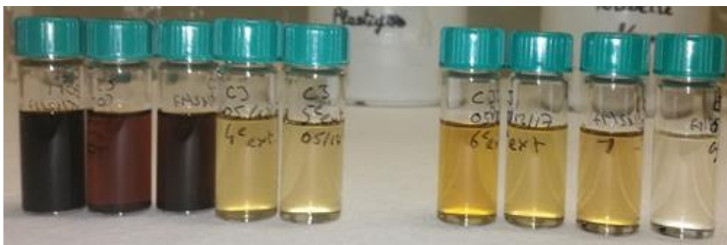
Figure 26 – Photo des flacons contenant les extraits des lavages successifs de la terre pour l'élimination de la Matière Organique Extractible : extraction manuelle (gauche - 1 à 5) et extraction automatisée ASE (droite - 6 à 9)
