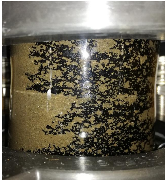
Figure 87 - Photographies des milieux poreux en cours de dopage avec du DNAPL par drainage-imbibition a) billes de verre, b) terre S-COK
