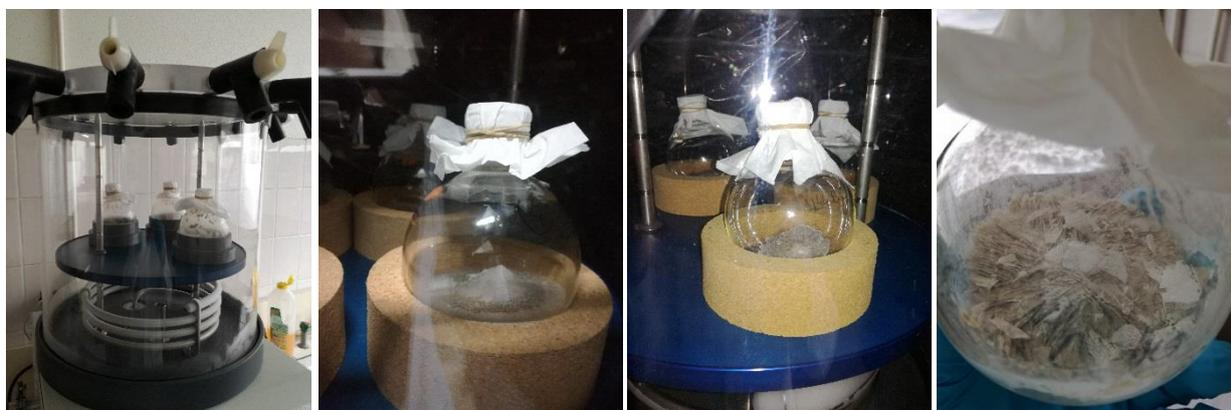
Figure 21 - Système de déshydratation par lyophilisation - expériences batch
