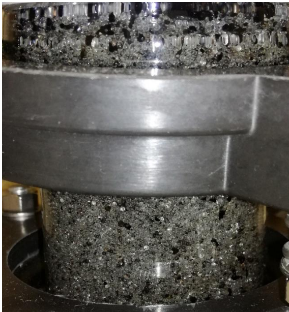
Figure 87 - Photographies des milieux poreux en cours de dopage avec du DNAPL par drainage-imbibition a) billes de verre, b) terre S-COK
