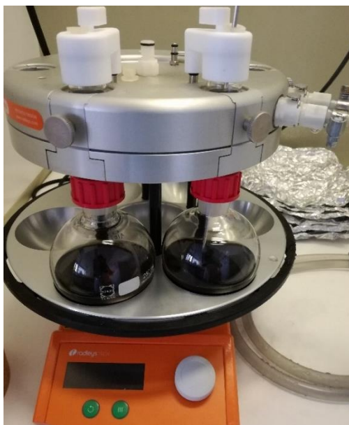
Figure 22 – Dispositif de l'extraction par chauffage à reflux (36°C) pour les tests en batch : bloc Radleystech chauffant avec agitation équipé d'un réfrigérant
