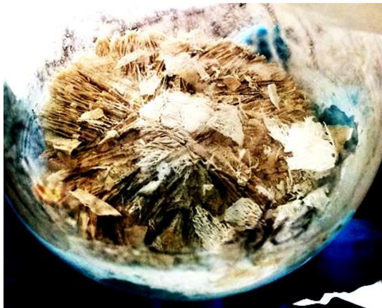
Figure 40 - Photographie des séparations de feuillets d'argiles du au sein des résidus secs suite à la lyophilisation, batch de terre S-COK traité par le ferrate (2)
