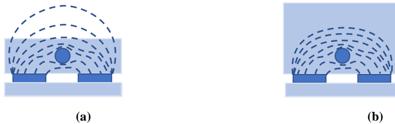
Figure 1-19. Schéma de la distribution du champ électrique (a) dans deux milieux différents et (b) pour une solution uniforme.
