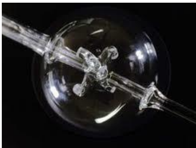
Figure : 11. Photo d'un réacteur à agité par jets gazeux. La buse d'injection en forme de croix est visible au centre du réacteur.
