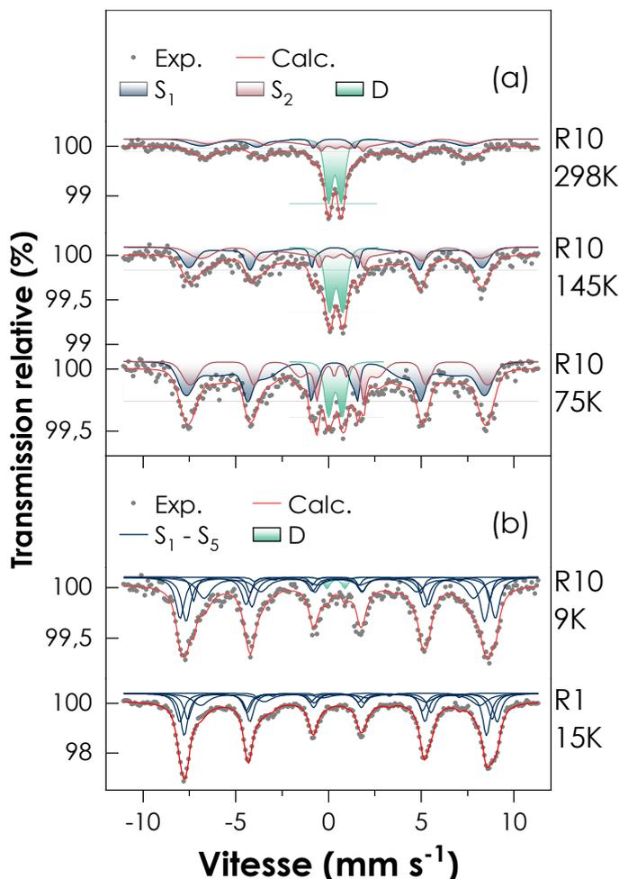
**Figure 3.10 :** Evolution du spectre Mössbauer en fonction de la température pour la MOP (R10). Les spectres sont ajustés en utilisant le modèle VBF (a) et le modèle lorentzien (b). Le spectre Mössbauer de la MOP (R1) à 15 K est donné à titre de comparaison.
