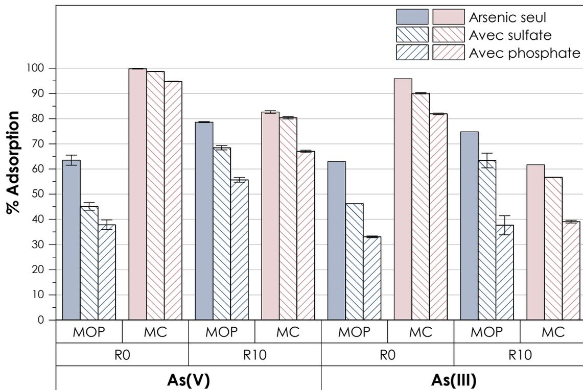
**Figure 5.6 :** Influence de la présence d'ions compétiteurs sur le pourcentage d'adsorption en As(V) et (III) par des échantillons de MOP et MC à différentes valeurs de R (Espèces : As (V) et As(III),  $C_0 = 0,1$  mmol,  $I = 0,1$  M, dose d'adsorbant =  $1,5$  g L<sup>-1</sup>)
