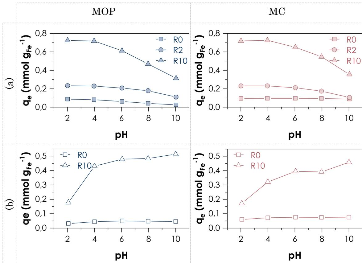
**Figure 5.5 :** Effet du pH sur l'adsorption de l'arsenic (V) (a) et de l'arsenic (III) (b) par des échantillons de magnétite à différentes valeurs de R synthétisées par oxydation-précipitation (gauche) et coprécipitation (droite) ; Symboles : données expérimentales ; Traits : aides visuelles (Espèces : As (V) et As(III),  $C_0 = 0,1 \text{ mmol}$ ,  $I = 0,1 \text{ M}$ , dose d'adsorbant =  $1,5 \text{ g L}^{-1}$ )
