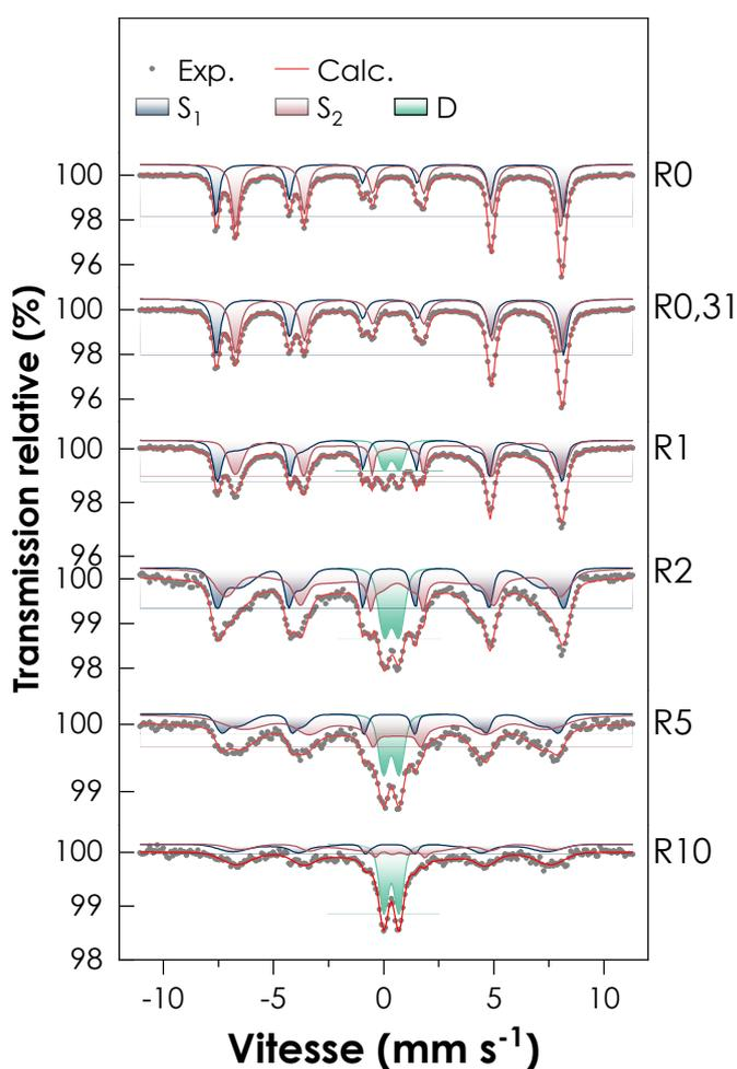
**Figure 3.9 :** Spectres Mössbauer à température ambiante pour des valeurs croissantes de R dans le cas des magnétite MOP. Les spectres sont ajustés en utilisant des profils lorentziens pour R0 et R0,31 et le modèle VBF de R1 à R10.
