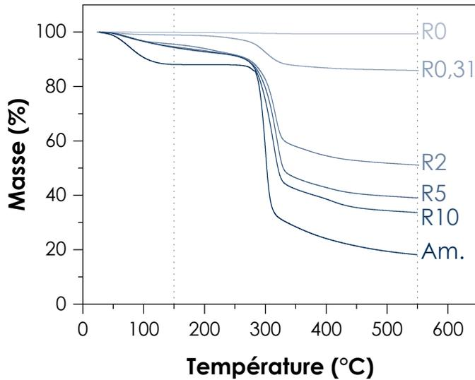
**Figure 3.1 :** Thermogrammes des échantillons MOP à différentes valeurs de R et de l'amidon obtenus sous atmosphère inerte (N<sub>2</sub>).
