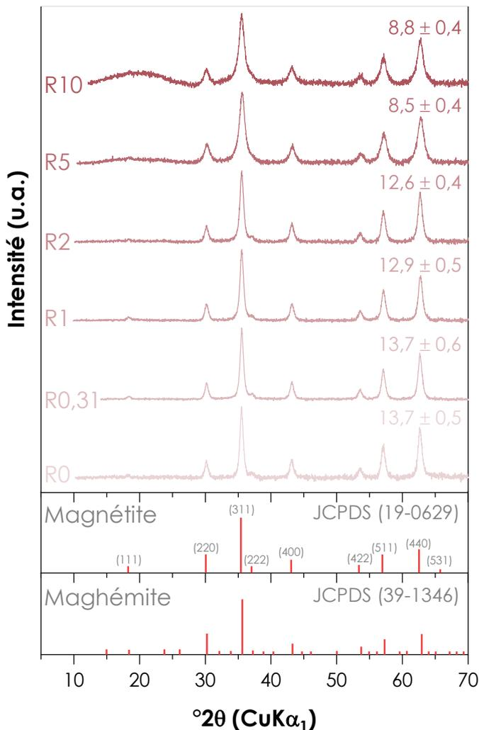
**Figure 3.6 :** Diffractogrammes des MC à différentes valeurs de R et diffractogrammes de référence pour la magnétite et la maghémite issues de la base de données JCPDS. La valeur au-dessus de la partie droite de chaque spectre représente la taille moyenne des cristallites (en nm) avec son écart-type calculé selon la formule de Scherrer en prenant en compte les pics (220), (311), (400), (511) et (440).
