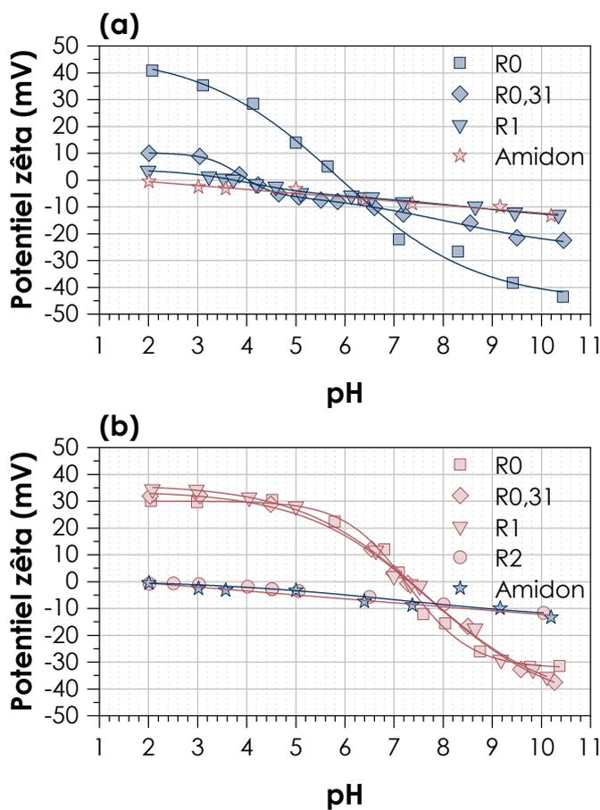
**Figure 3. 17 :** Variation du potentiel zêta en fonction du pH : échantillons MOP R(0, 0,31 et 1) et amidon gélatinisé (a), échantillons MC (R0, 0,31, 1 et 2) et amidon (b) dans une solution de KCl  $10^{-3}$  M. Symboles : données expérimentales ; lignes : ajustements par une fonction sigmoïde.
