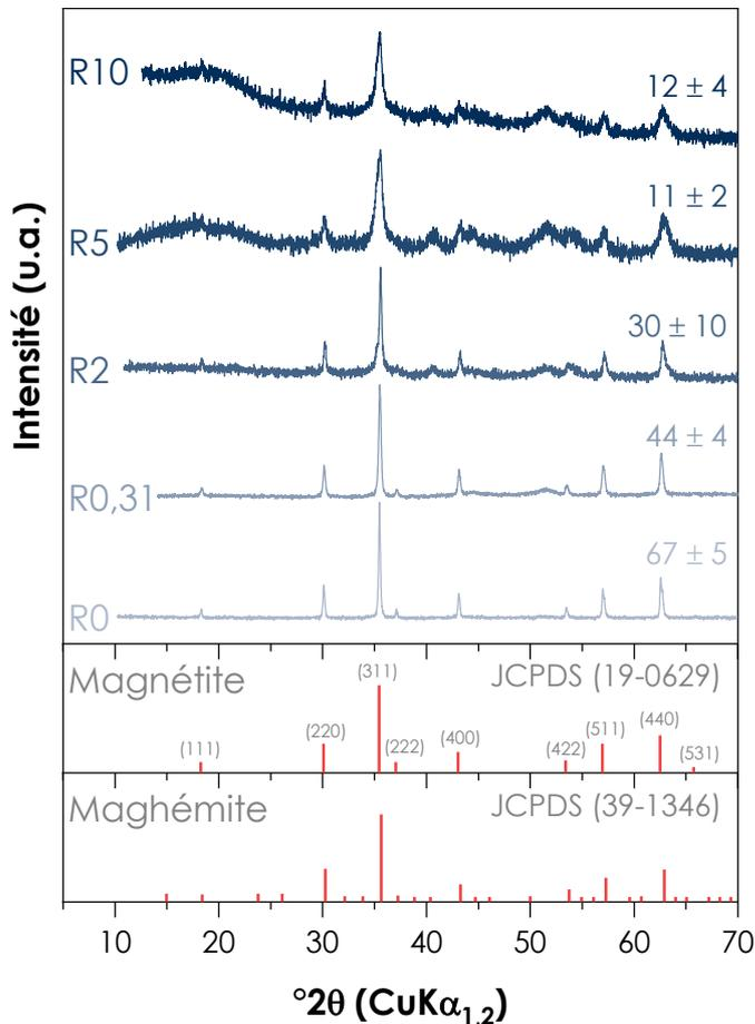
**Figure 3.5 :** Diffractogrammes des échantillons MOP à différentes valeurs de R et diffractogrammes de référence pour la magnétite et la maghémite issues de la base de données JCPDS. La valeur au-dessus de la partie droite de chaque spectre représente la taille moyenne des cristallites en (nm) avec son écart-type calculé selon la formule de Scherrer en prenant en compte les pics (311) et (440).
