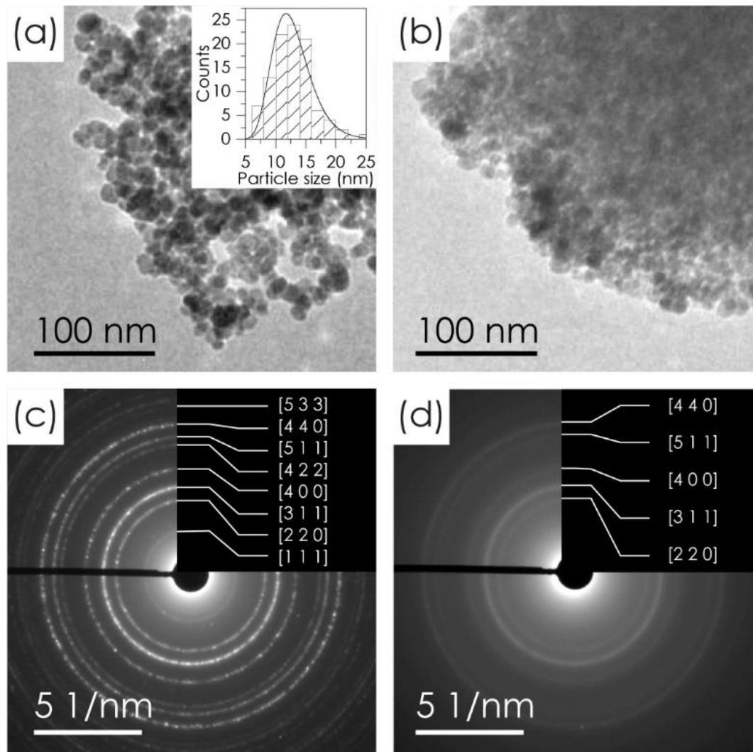
**Figure 3.4 :** Micrographies MET des échantillons MC non fonctionnalisée R0 (a) et fonctionnalisée R10 (b) ; clichés SAED des MC non fonctionnalisée R0 (c) et fonctionnalisée R10 (d). L'insert dans la figure (a) donne la distribution des tailles des particules ajustée avec un profil log-normal.
