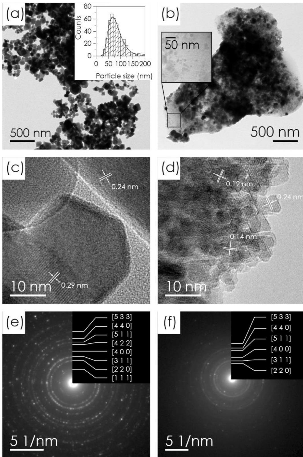
**Figure 3.3 :** Micrographies MET des échantillons MOP non fonctionnalisée R0 (a) et fonctionnalisée R10 (b) ; micrographies MET hautes résolutions des MOP non fonctionnalisée R0 (c) et fonctionnalisée R10 (d) ; clichés SAED des MOP non fonctionnalisée R0 (e) et fonctionnalisée R10 (f). L'insert dans la figure (a) donne la distribution de tailles des particules ajustée avec un profil log-normal.
