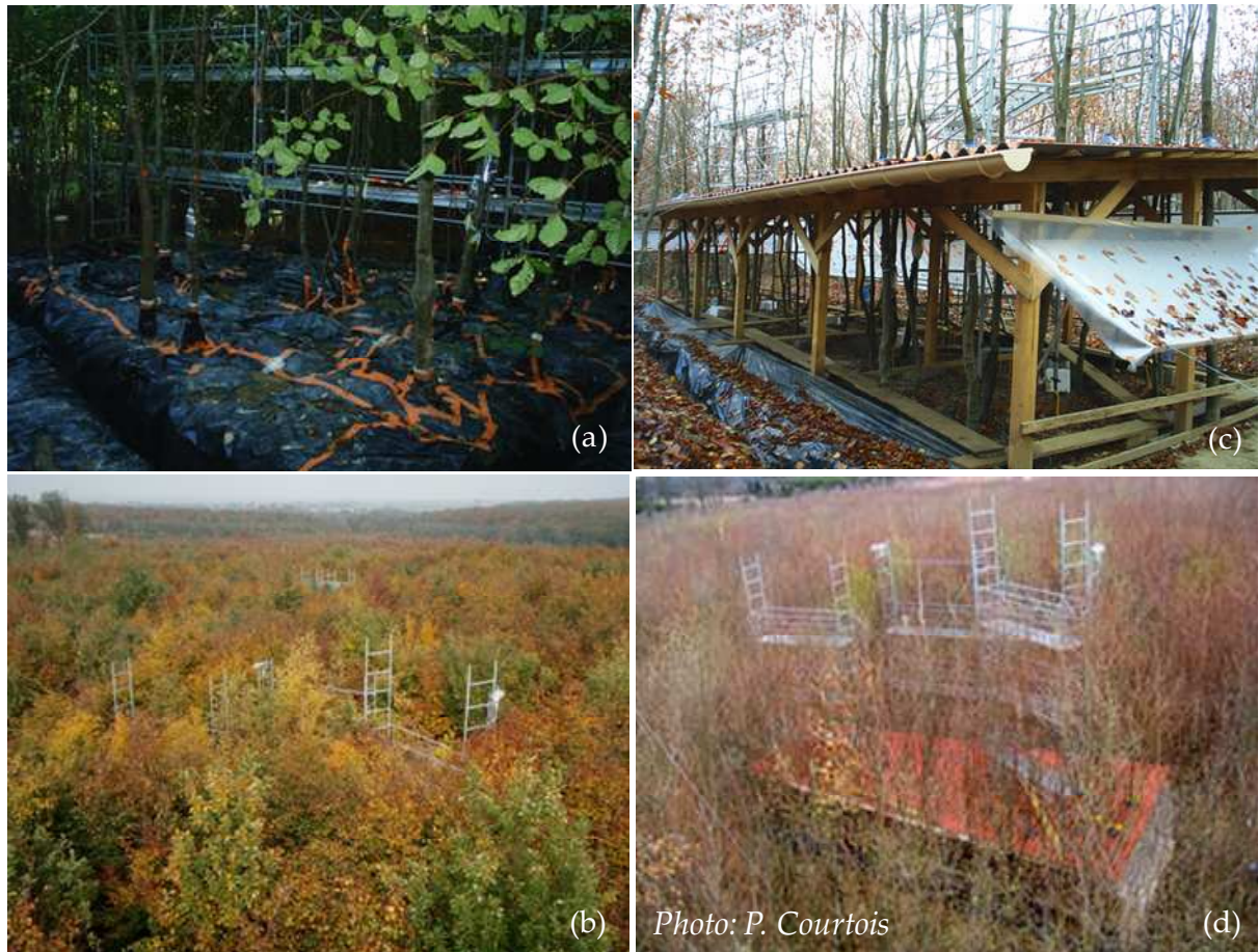
Figure 5 : Site expérimental : dispositif d'exclusion des pluies en 2006 (a) et 2007 (c, d) et vue d'ensemble (b).
