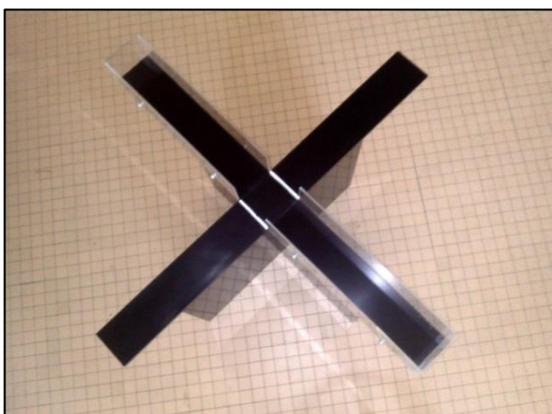
*Figure 14 : Labyrinthe en croix surélevé utilisé dans l'étude. Ce labyrinthe est surélevé par rapport au sol de 68 cm et est constitué de deux bras ouverts (longueur : 45 cm, largeur : 10 cm) disposés perpendiculairement à deux bras cloisonnés dont les parois sont transparentes (longueur : 45 cm, largeur : 10 cm, hauteur : 9 cm). Les quatre bras sont reliés entre eux par une plateforme centrale (10 x 10 cm).*
