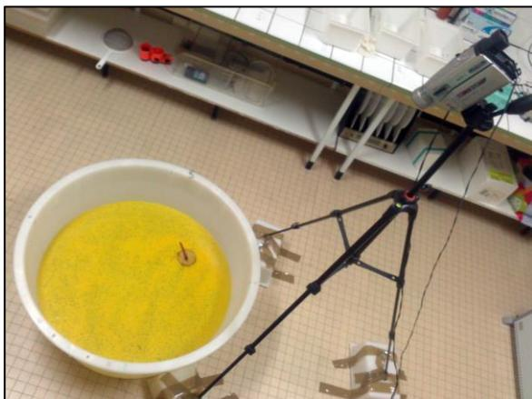
*Figure 19 : Dispositif du test d'apprentissage visuo-spatial de la piscine de Morris utilisé pour l'étude. Le bassin circulaire a une hauteur de 30 cm, un diamètre de 86 cm, et est rempli d'eau tempérée à 21-22°C. Ici, la photographie montre le test de la plateforme visible dans lequel la plateforme (diamètre 12 cm) est positionnée au Sud-Est. Une caméra surplombant la piscine permet à l'observateur resté à distance d'observer sans perturber le parcours de la souris.*
