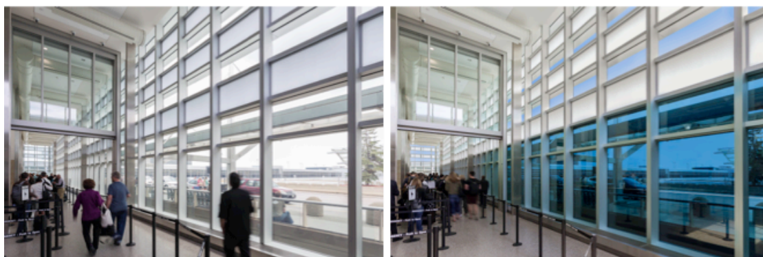
Figure II.33 : Fenêtres électrochromes à base de WO_3 (© SageGlass)
